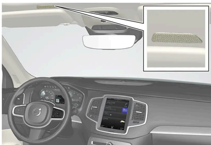
Micrófono del sistema de control por voz
