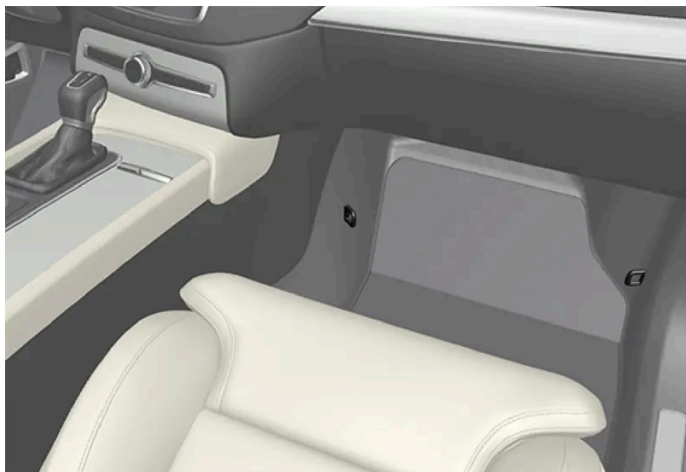
Ubicación de los puntos de fijación en el asiento delantero.
