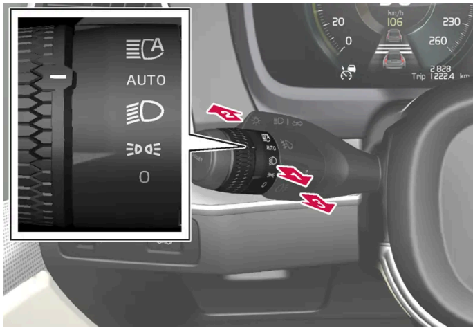
Palanca del volante con mando giratorio.
