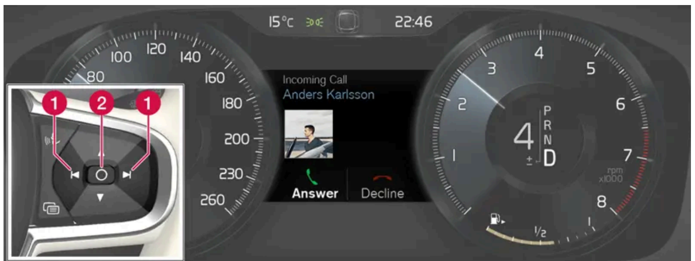
Ejemplo de mensaje en la pantalla del conductor y teclado derecho del volante. La imagen es esquemática. Los detalles pueden variar según el modelo de automóvil.
