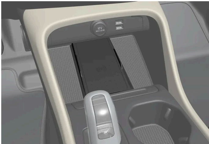
Cargador de teléfono inalámbrico delante de la palanca de cambios
