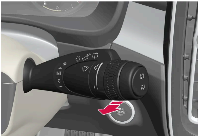
Función de lavado, palanca derecha del volante.
