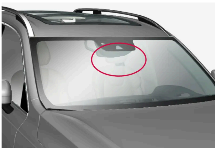
Ubicación de la unidad de cámara
