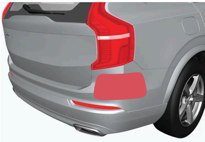
Ubicación de unidades de radar traseras
