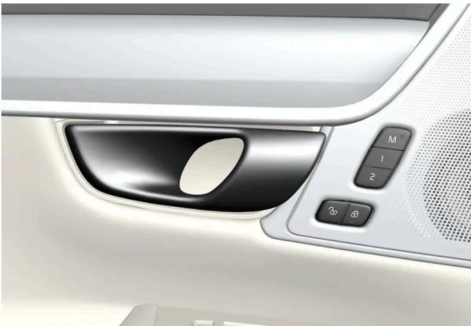
Manilla de apertura para desbloqueo alternativo de la puerta lateral [1] .
