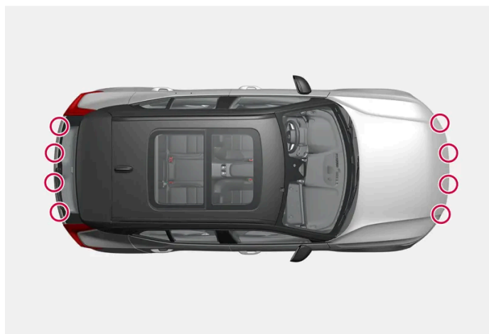
Ubicación de los sensores de estacionamiento alrededor del automóvil
