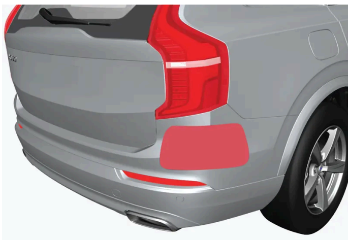
Ubicación de unidades de radar traseras
