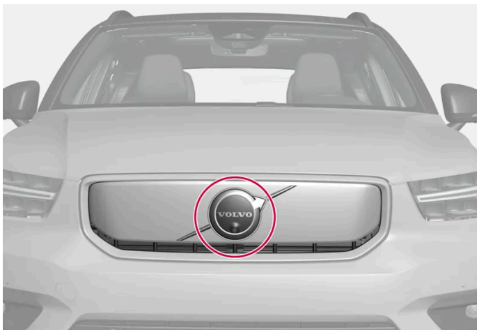
Ubicación de la unidad delantera de radar
