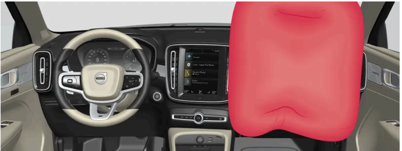
Airbag en el asiento delantero del acompañante.
