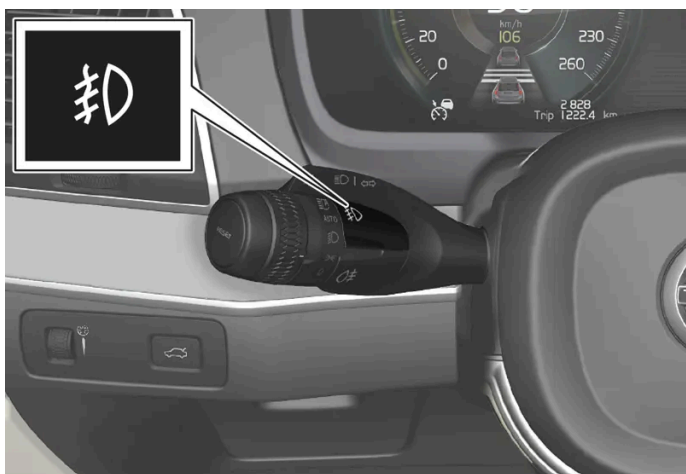
Botón para la luz antiniebla delantera.
