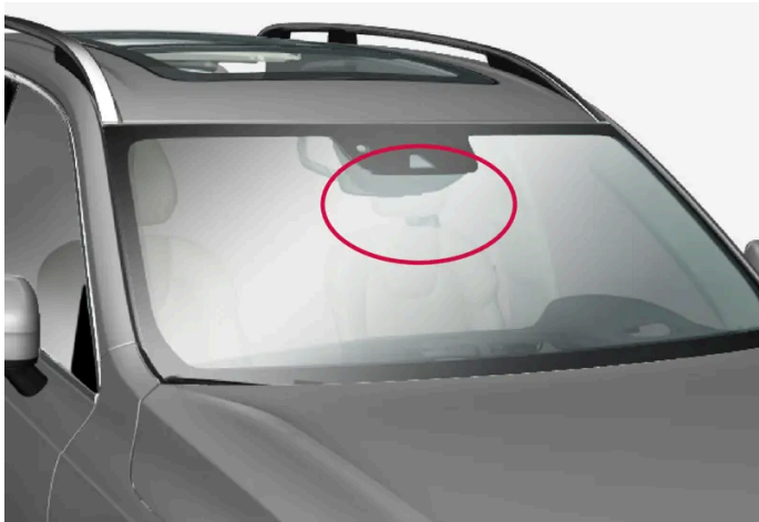
Ubicación de la unidad de cámara delantera
