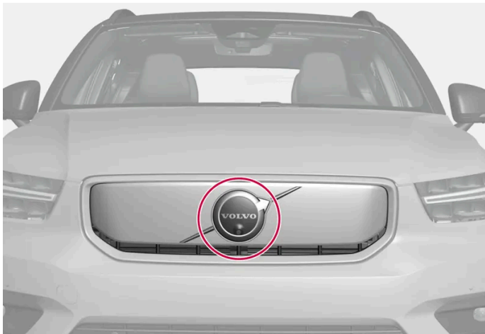
Ubicación de la unidad delantera de radar
