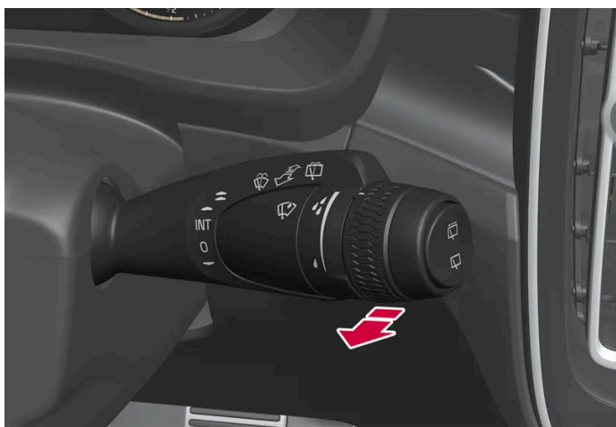
Función de lavado, palanca derecha del volante.
