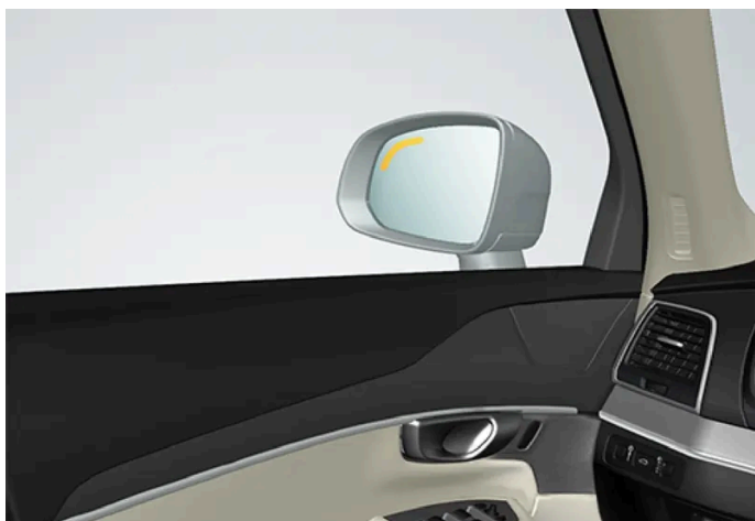
Ubicación del testigo de BLIS
