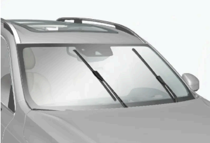
Escobillas de limpiaparabrisas en posición de servicio.
