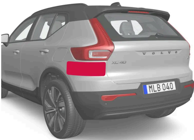
Ubicación de unidades de radar traseras
