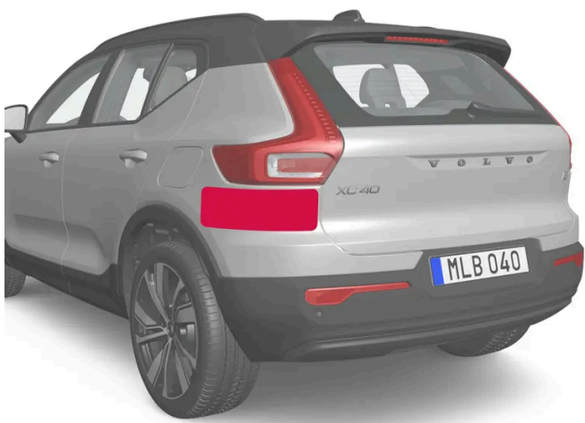
Ubicación de unidades de radar traseras
