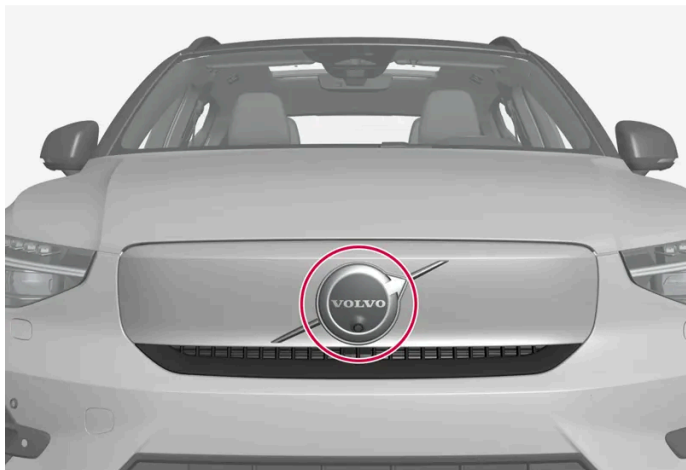
Ubicación de la unidad delantera de radar
