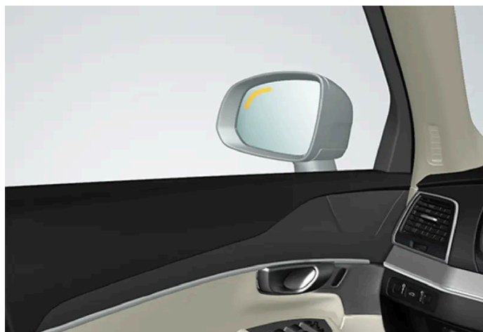
Ubicación del testigo de BLIS
