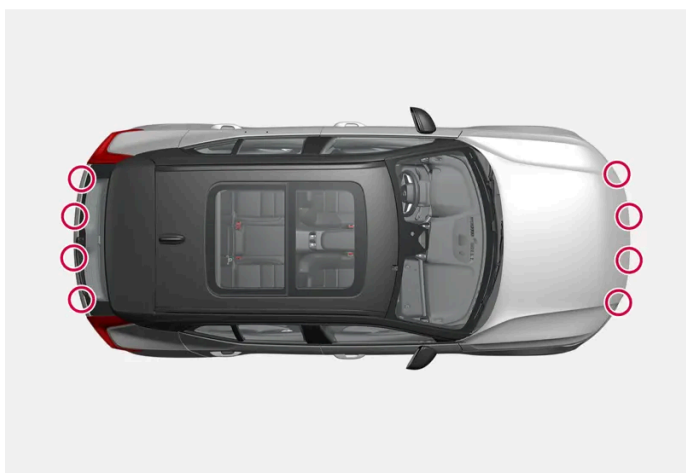
Ubicación de los sensores de estacionamiento alrededor del automóvil
