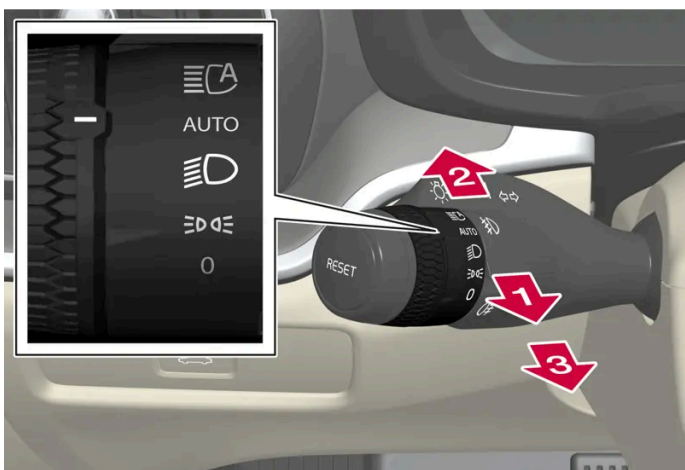
Palanca del volante con mando giratorio.
