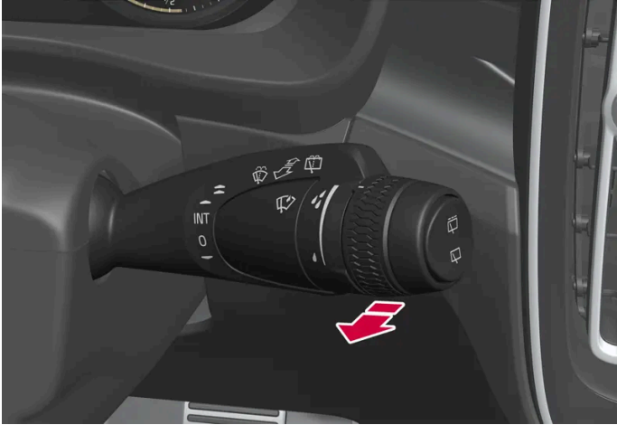
Función de lavado, palanca derecha del volante.
