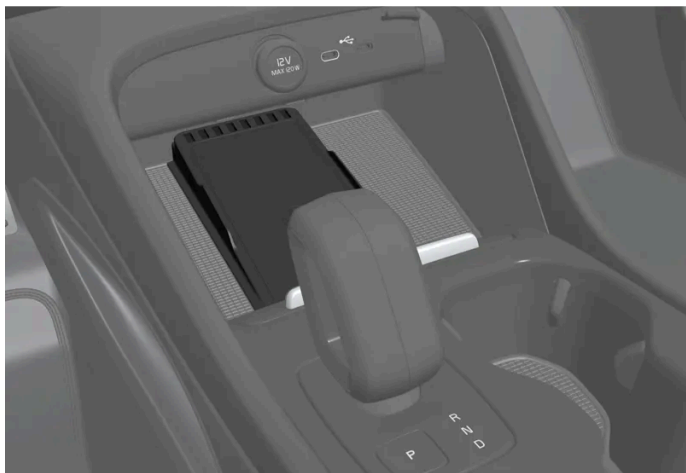
Cargador inalámbrico bajo la pantalla central.
