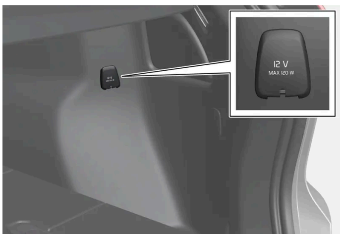
Toma eléctrica de 12 V en el compartimento de carga*. [1]
