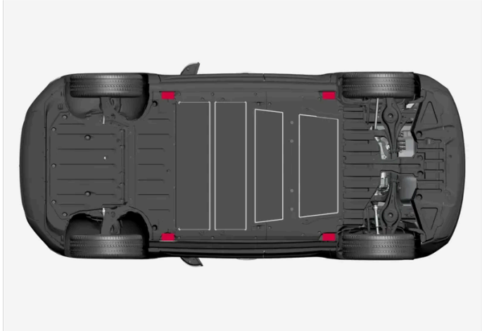
Puntos de elevación del automóvil para levantamiento con gato.
