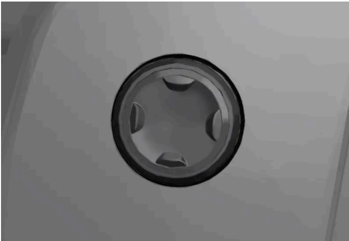
Botón de cuatro direcciones, situado en el lateral de la almohadilla del asiento.
