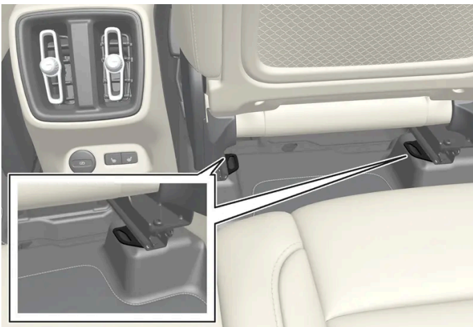
Ubicación de los puntos de fijación en el asiento trasero.
