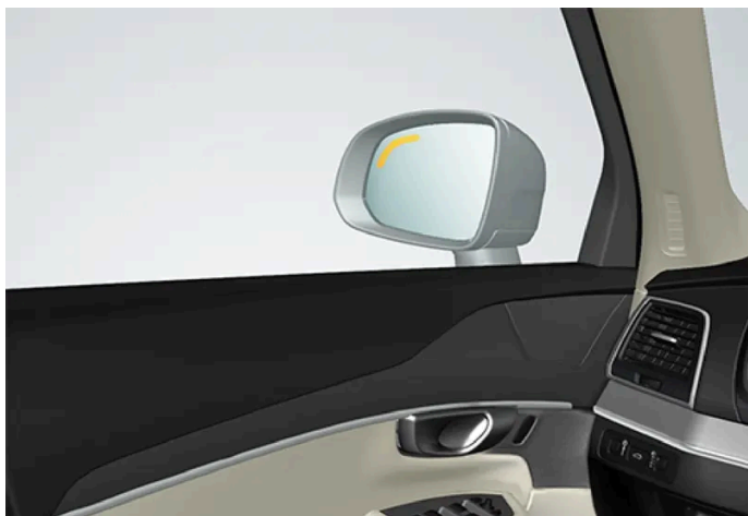
Ubicación del testigo de BLIS
