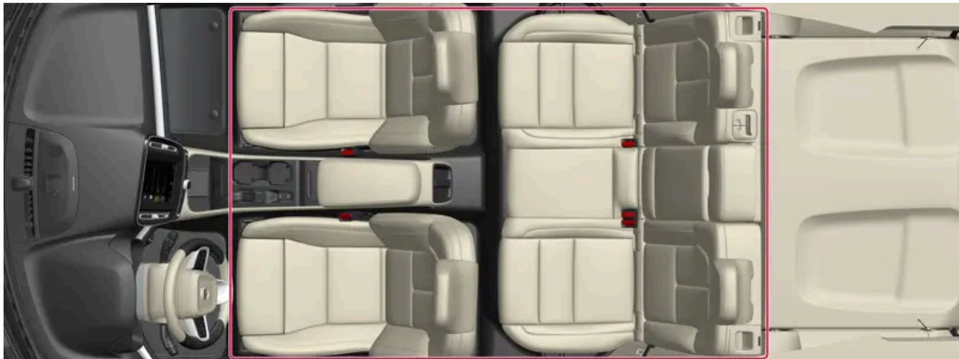
Zonas de climatización con climatización de 1 zona.
