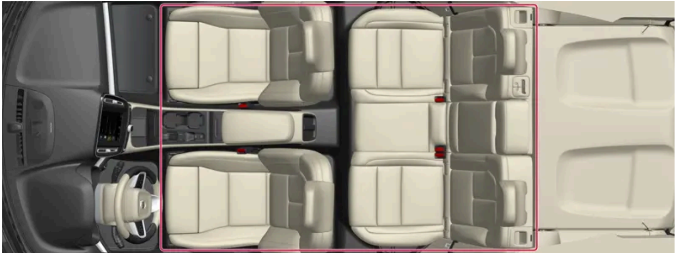
Zonas de climatización con climatización de 1 zona.
