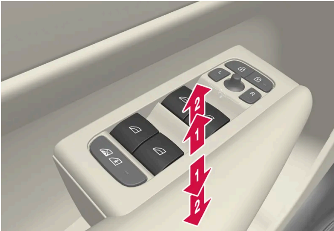
Accionamiento de los elevalunas eléctricos.
