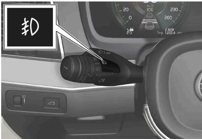
Botón para la luz antiniebla delantera.
