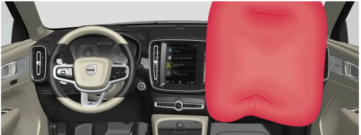
Airbag en el asiento delantero del acompañante.
