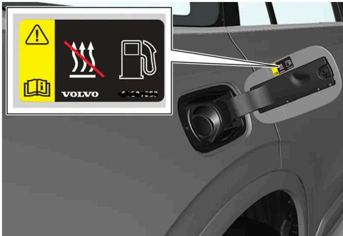
Placa de advertencia en la tapa del depósito de combustible.
