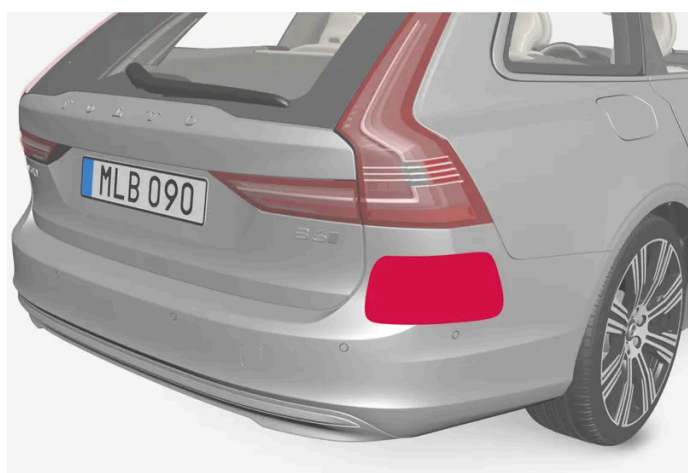
Ubicación de unidades de radar traseras
