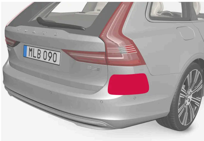
Ubicación de unidades de radar traseras
