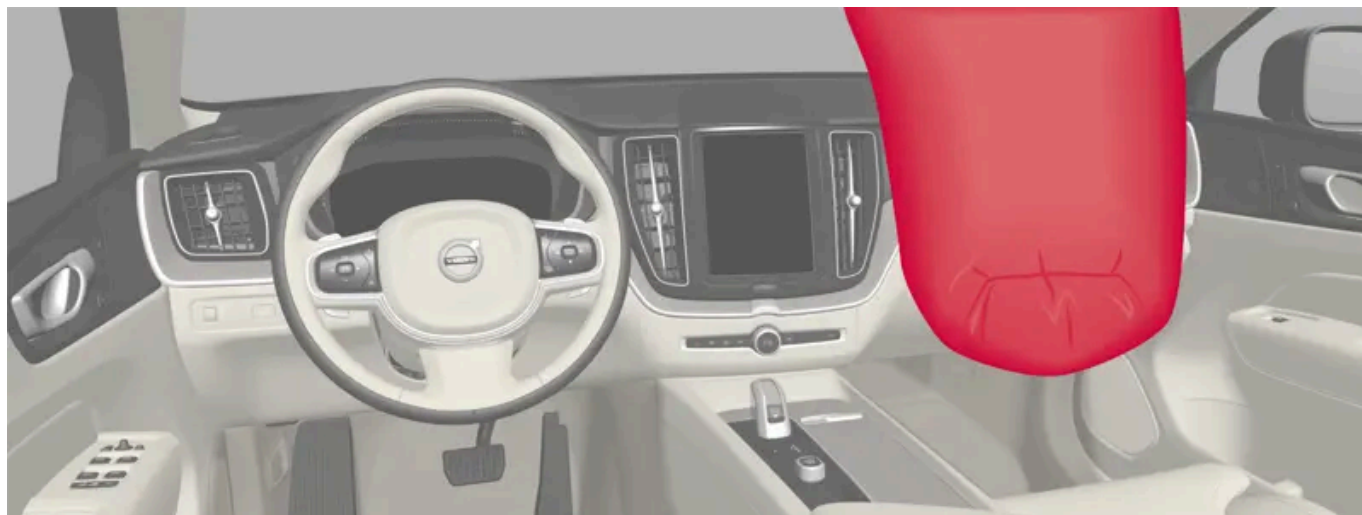
Airbag en el asiento delantero del acompañante.
