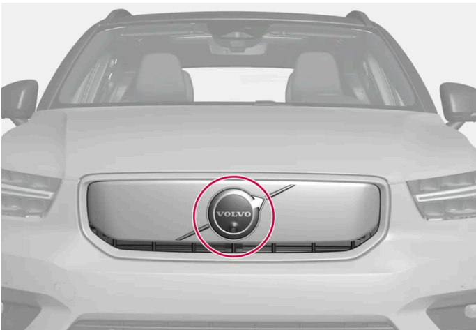
Ubicación de la unidad delantera de radar
