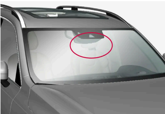
Ubicación de la unidad de cámara delantera
