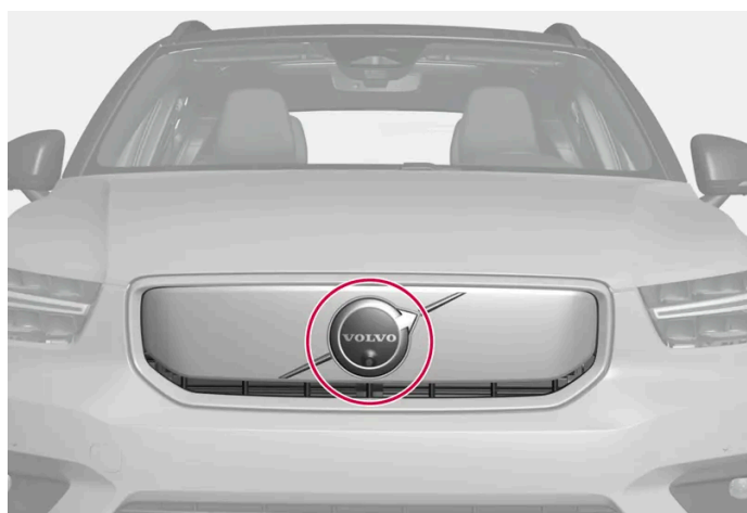
Ubicación de la unidad delantera de radar
