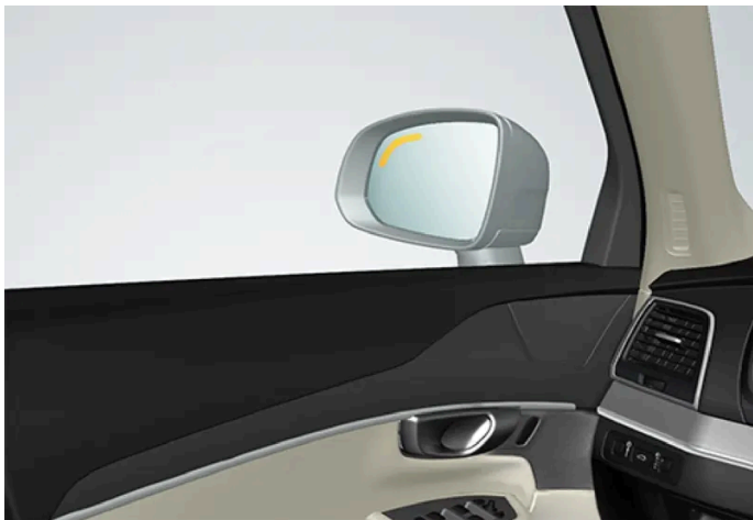
Ubicación del testigo de BLIS
