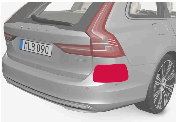
Ubicación de unidades de radar traseras
