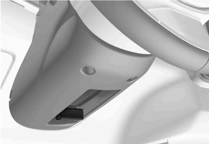
Palanca de regulación del volante.
