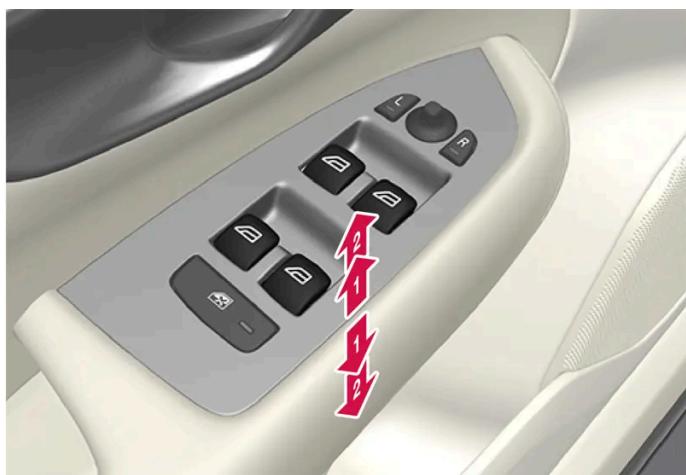
Accionamiento de los elevallunas eléctricos.
