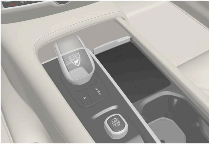
Cargador inalámbrico en la consola del túnel.
