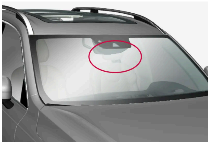
Ubicación de la unidad de cámara delantera
