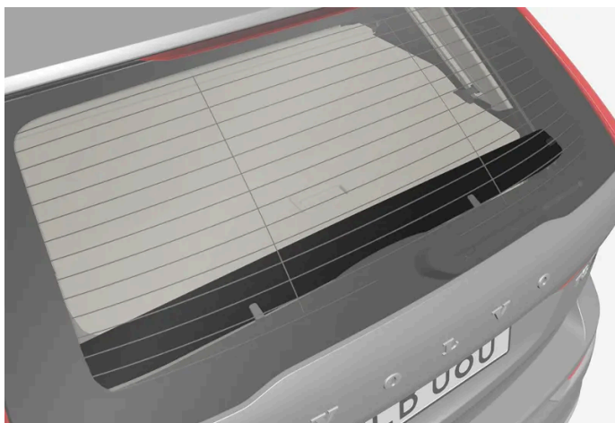
El tablero de revestimiento trasero montado sobre el interior del portón trasero sirve de complemento del cubreobjetos.
