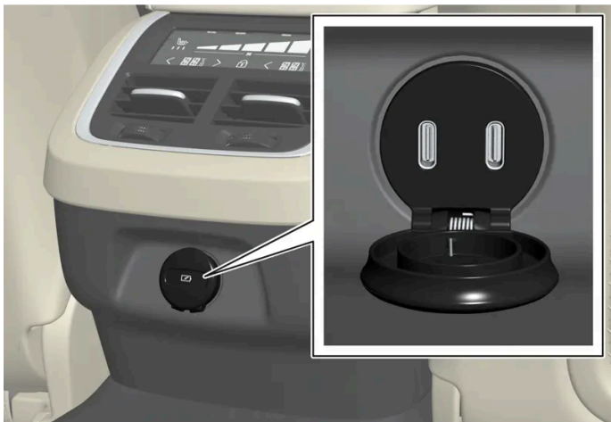
Puertos USB (tipo C) de la consola del túnel, asiento trasero.
