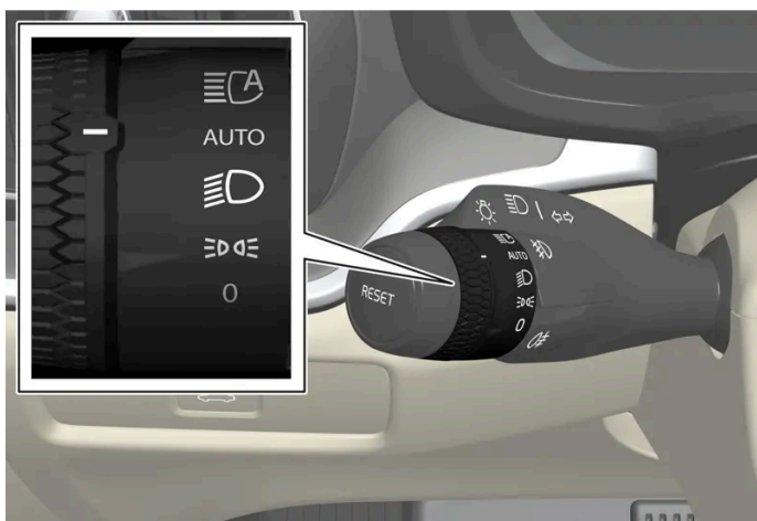
Mando giratorio de palanca izquierda del volante.
