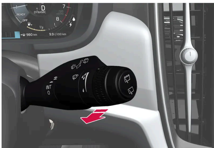
Función de lavado, palanca derecha del volante.
