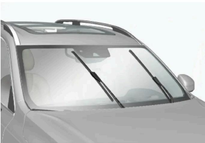
Escobillas de limpiaparabrisas en posición de servicio.
