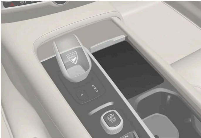
Cargador de teléfono inalámbrico en la consola del túnel.
