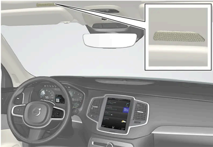
Micrófono del sistema de control por voz
