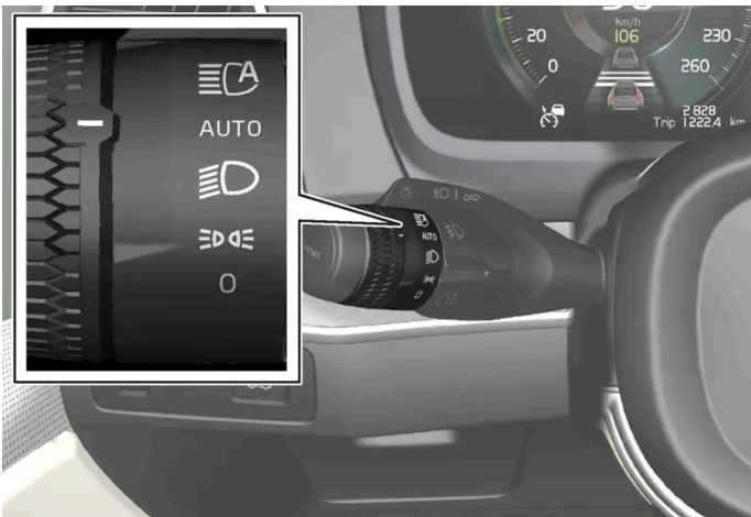
Mando giratorio de palanca izquierda del volante.
