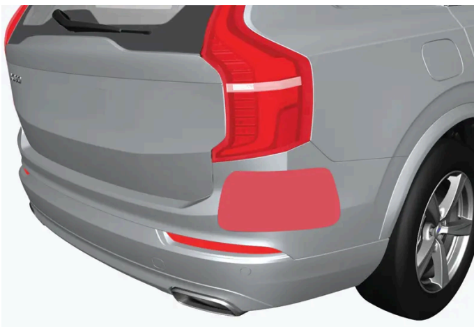
Ubicación de unidades de radar traseras
