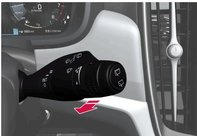
Función de lavado, palanca derecha del volante.
