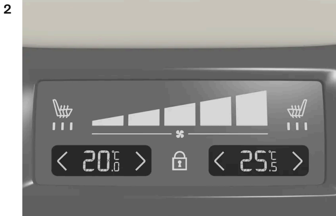
Control de temperatura en el panel de climatización de la consola del túnel.
