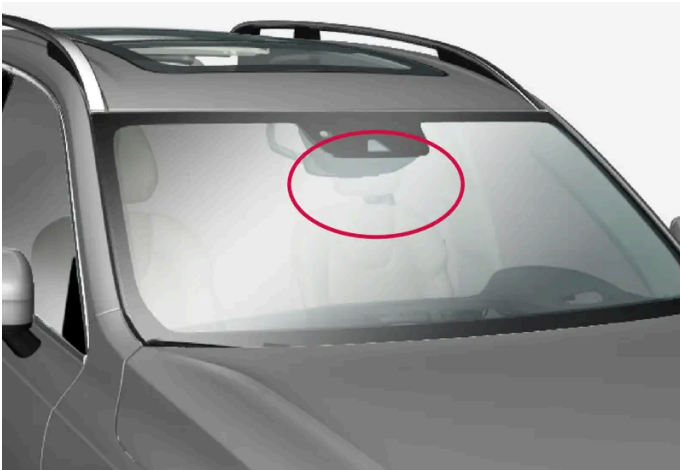
Ubicación de la unidad de radar y cámara delantera
