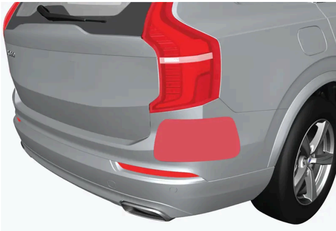
Ubicación de unidades de radar traseras
