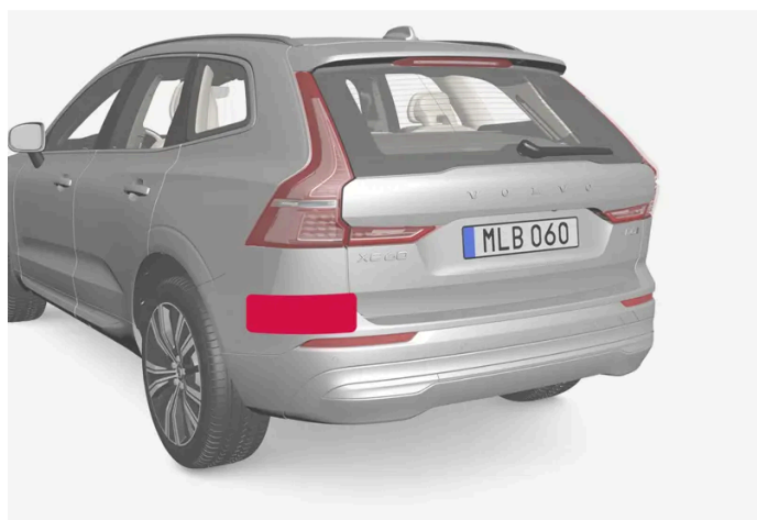
Ubicación de unidades de radar traseras
