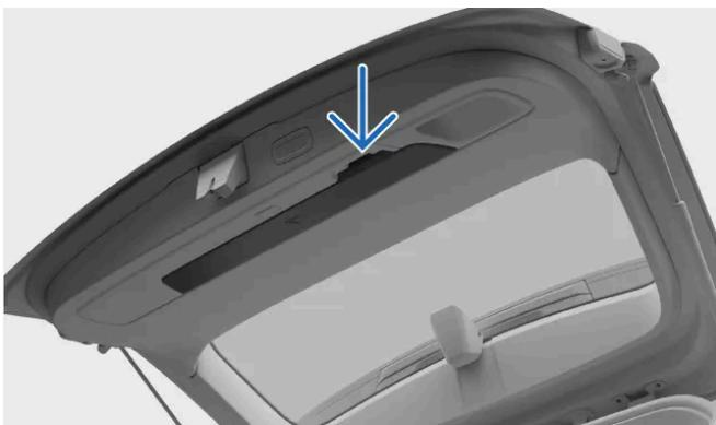
El triángulo de advertencia se encuentra en el interior de la compuerta del maletero. Tire de la manilla para abrirla.
