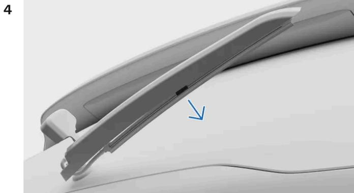
Tire de la escobilla hacia abajo hasta que se afloje y se suelte del brazo limpiaparabrisas.
