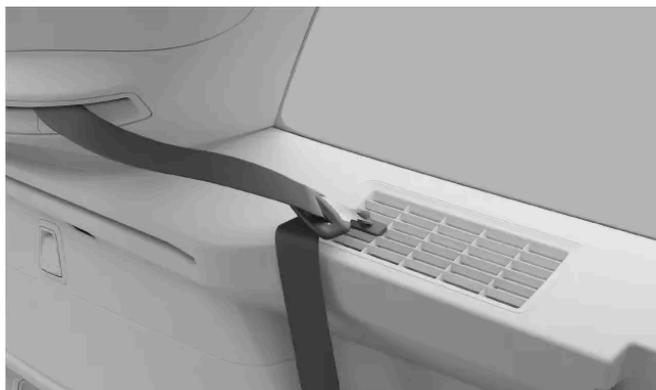
Aparte el cinturón de seguridad de la tercera fila cuando utilice la cubierta de equipajes. Retraiga el cinturón de seguridad y cúéguelo por la hebilla.
