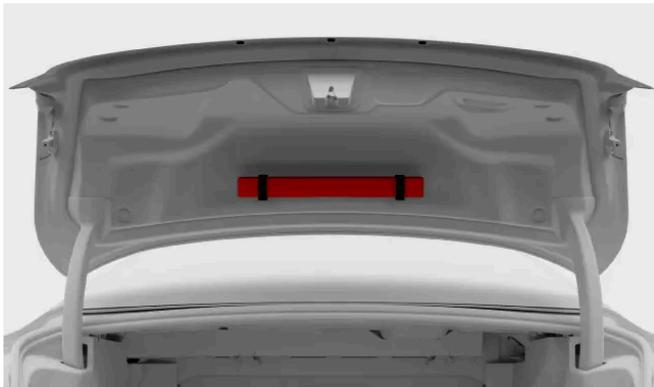
El triángulo de advertencia se encuentra en el interior de la compuerta del maletero. Abra el compartimento girando las manillas hasta que queden en posición vertical y luego tirando.
