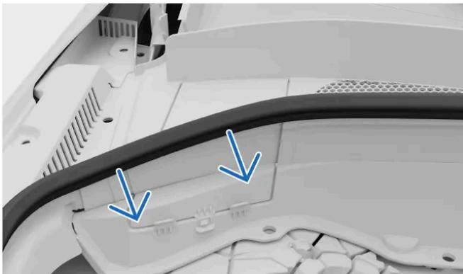
El recipiente del refrigerante se encuentra en la esquina superior izquierda del compartimento del motor, debajo de la trampilla de un panel. Tire de la junta de goma hacia el compartimento del motor para acceder a la trampilla.
