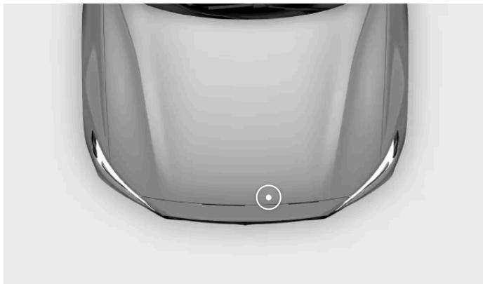
La segunda palanca se encuentra debajo del borde delantero del capó, en el lado del conductor.
