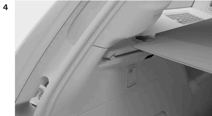
Deslice los extremos de la pantalla de la cubierta de equipajes en las ranuras superiores de los paneles laterales.
