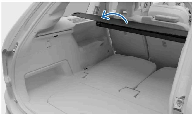
Tire del asa de la pantalla de la cubierta de equipajes por encima de los paneles laterales del maletero.
