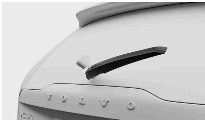
Agarre la parte central del brazo del limpiaparabrisas, elévelo y aléjelo del parabrisas trasero. Puede que detecte un poco de resistencia a medio camino, es la posición de bloqueo. Debe tirar del brazo y pasar de esa posición de bloqueo para que no vuelva a caer encima del parabrisas.
