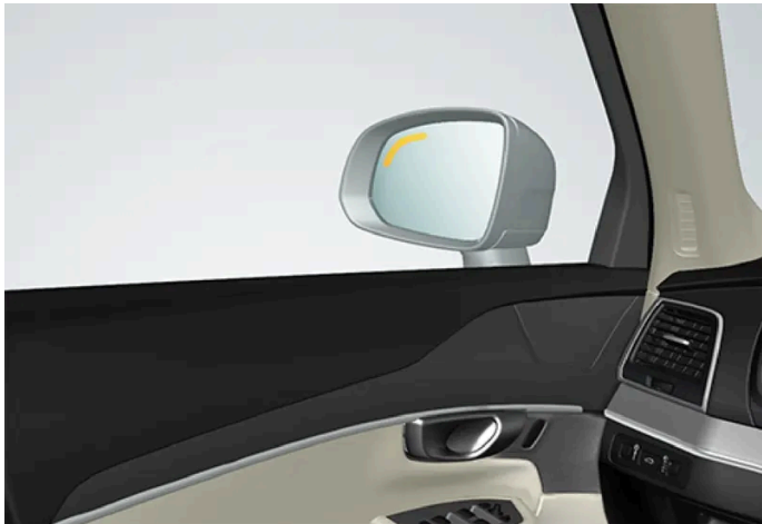
Ubicación del testigo de BLIS
