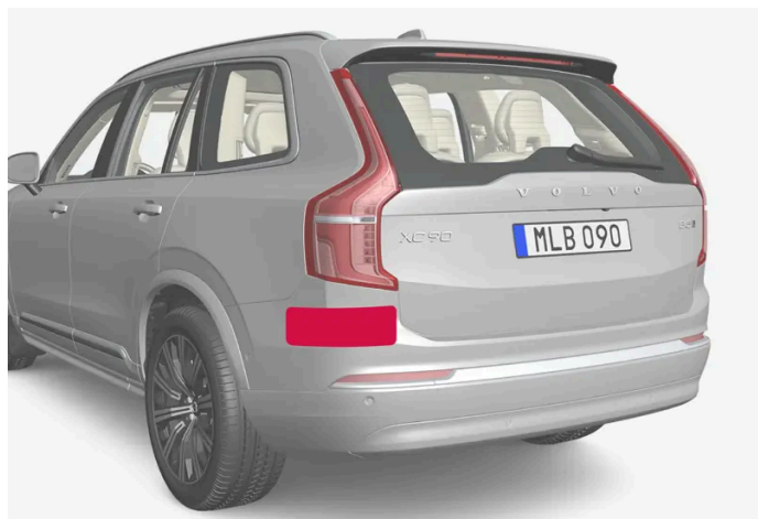
Ubicación de unidades de radar traseras
