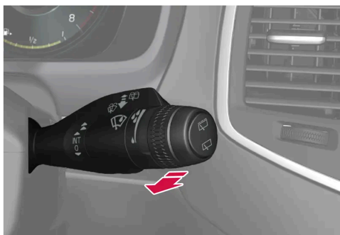
Función de lavado, palanca derecha del volante.
