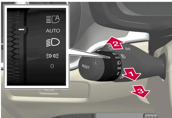
Palanca del volante con mando giratorio.
