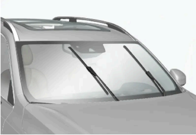
Escobillas de limpiaparabrisas en posición de servicio.
