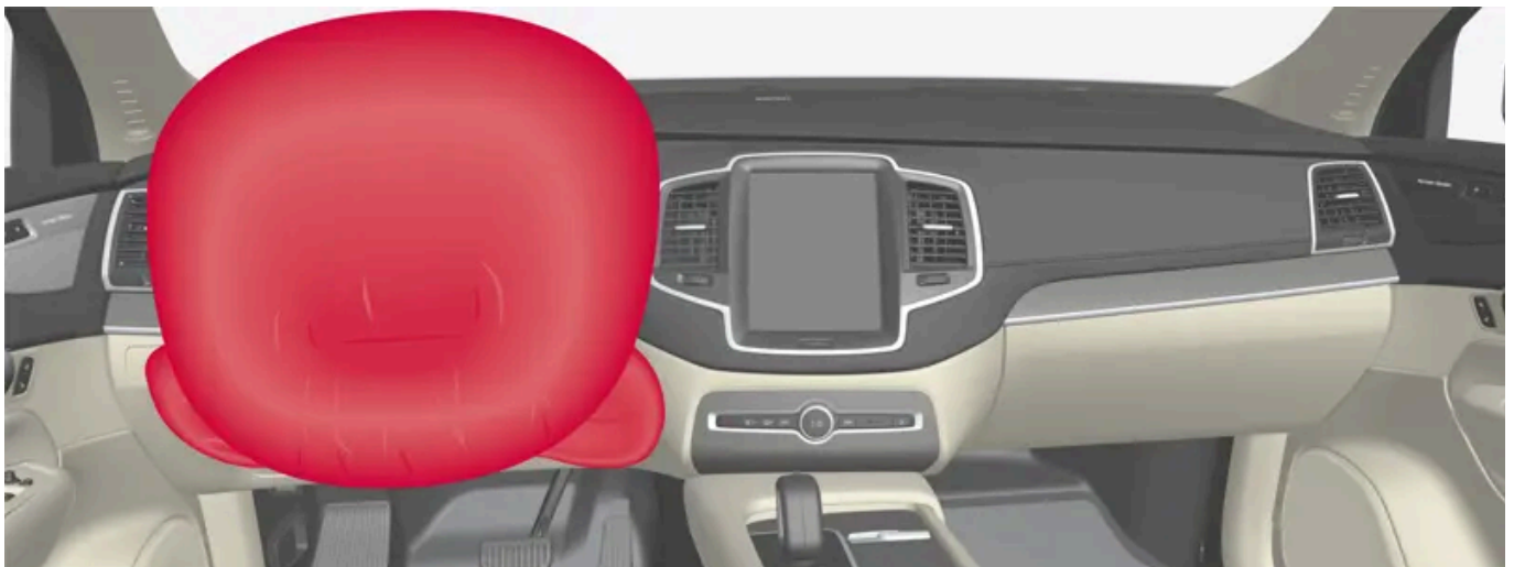
Airbag del volante y airbag de rodillas en el lado del conductor del asiento delantero.
