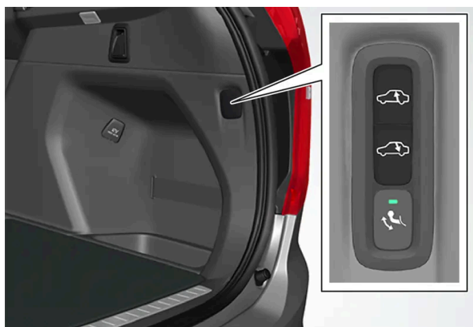
Control de elevación y descenso de la sección trasera del vehículo.
