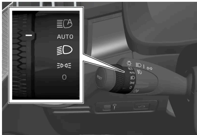
Molette du levier gauche au volant
