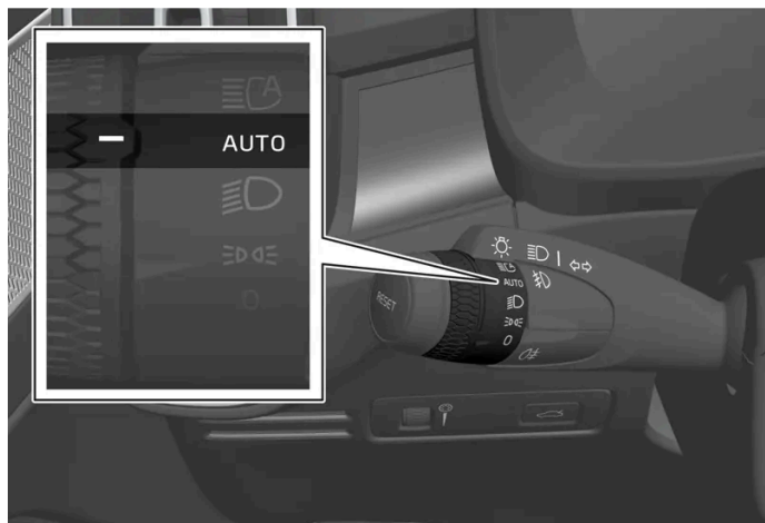
Molette du levier de volant en position AUTO .
