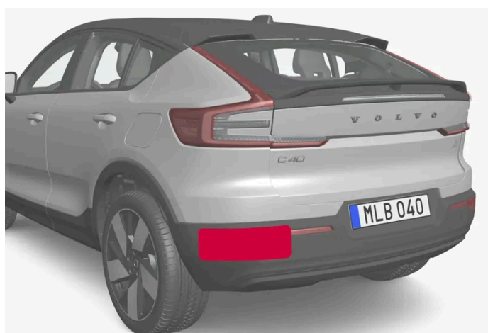
Position des unités radar arrière
