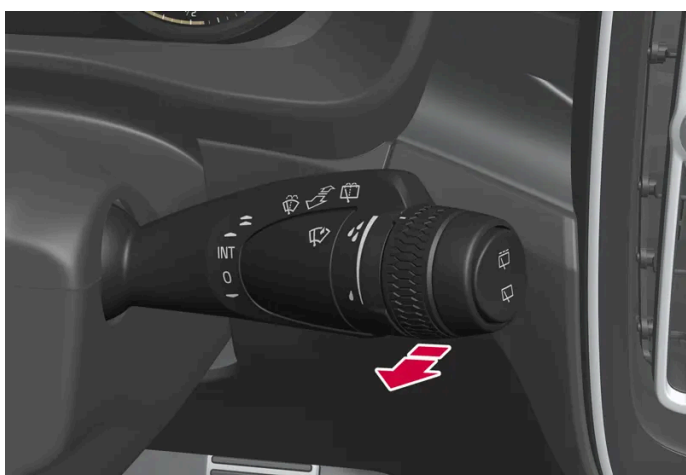
Fonction lave-glace, levier droit au volant
