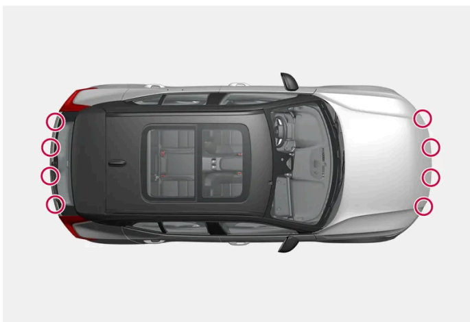
Position des capteurs de stationnement sur le pourtour de la voiture
