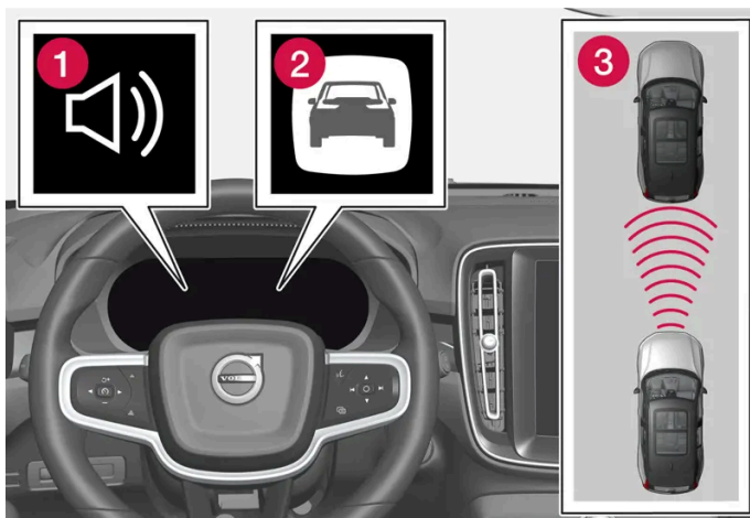
Signal acoustique et symbole pour l'avertissement de collision
