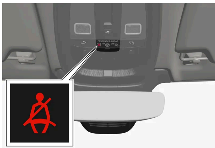
Rappel lumineux sur la console de plafonnier
