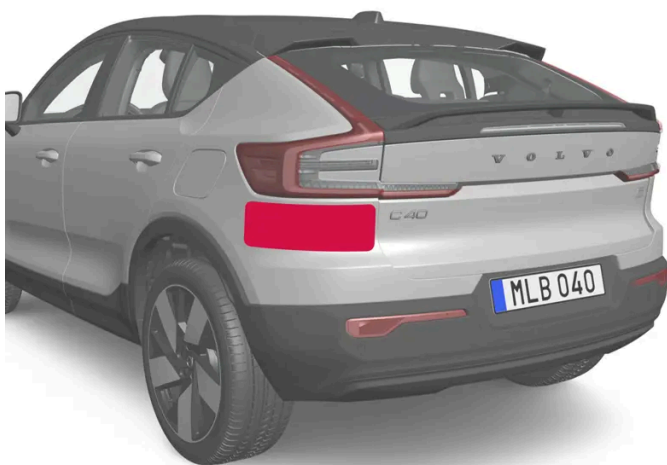
Position des unités radar arrière
