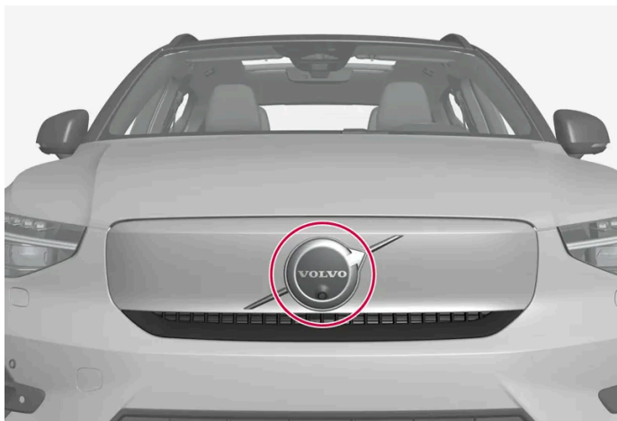
Position de l'unité radar avant
