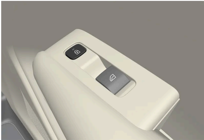
Bouton de verrouillage de porte arrière avec témoin
