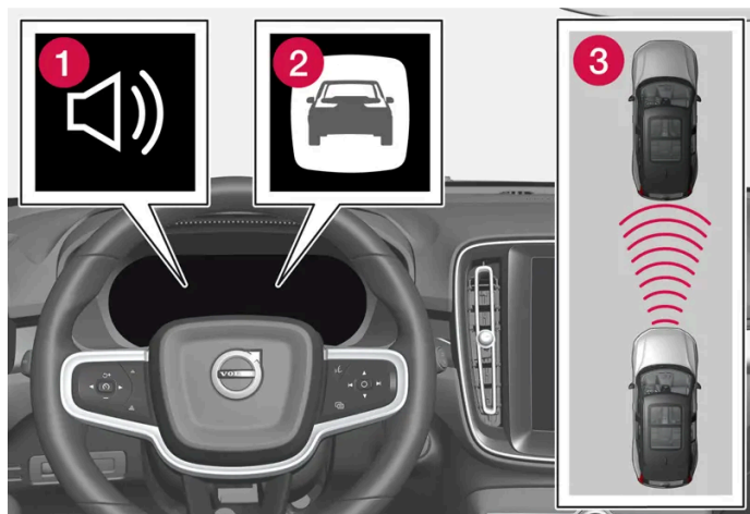
Signal acoustique et symbole pour l'avertissement de collision
