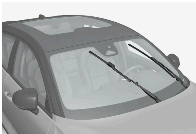
Balais d'essuie-glace en position d'entretien.
