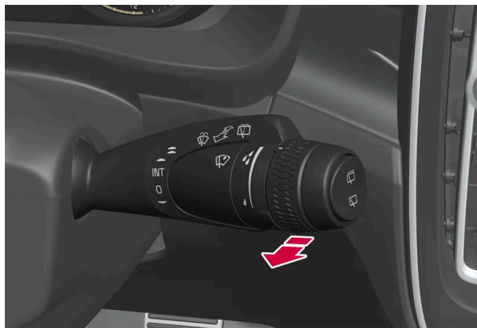
Fonction lave-glace, levier droit au volant
