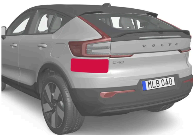
Position des unités radar arrière
