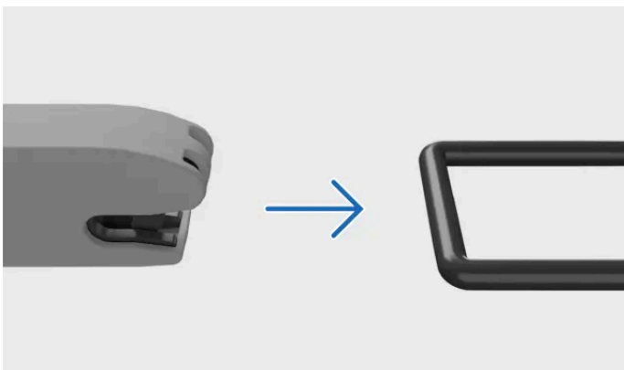
Installation d'un siège pour enfant avec le système ISOFIX
