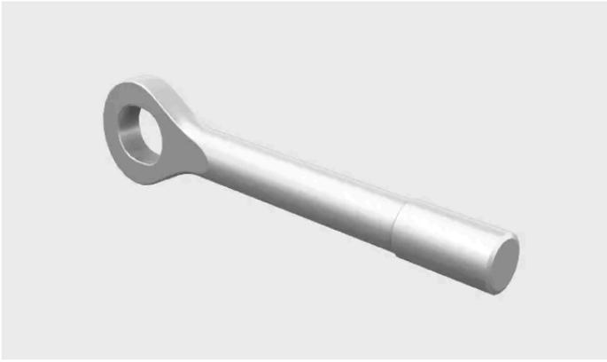
L'œillet de remorquage peut être fixé au pare-chocs de la voiture. Il peut également être utilisé pour arrimer des objets placés sur le toit qui dépassent du toit. Lors du remplacement d'une roue, l'œillet de remorquage peut être vissé sur la clé pour écrous de roue pour allonger la poignée.
