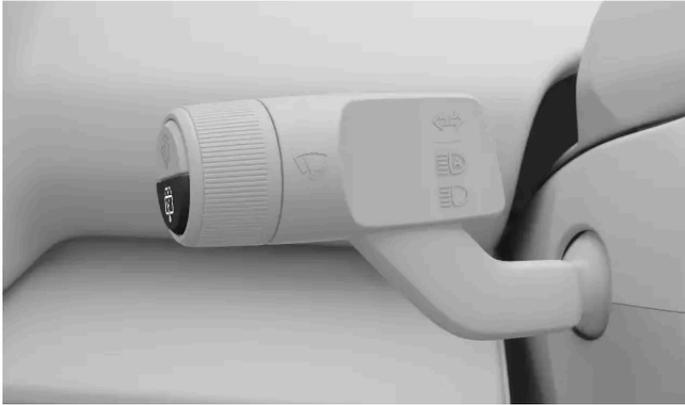
L'essuie-glace de lunette arrière est commandé manuellement à l'aide du levier au volant gauche.
