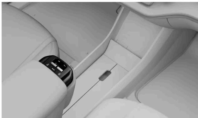
Vous pouvez commander toutes les vitres électriques depuis le siège avant. Appuyez sur le bouton portant la mention REAR pour alterner l'actionnement des vitres avant et arrière. Le bouton prend la couleur ambre pour indiquer que les vitres arrière sont sélectionnées. Les commandes repassent aux vitres avant si vous appuyez à nouveau sur le bouton ou au bout de quelques secondes d'inactivité.
