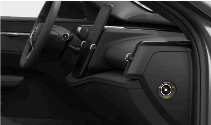
L'interrupteur de coussin gonflable est situé sur le côté du tableau de bord et il est accessible lorsque la porte passager avant est ouverte.
