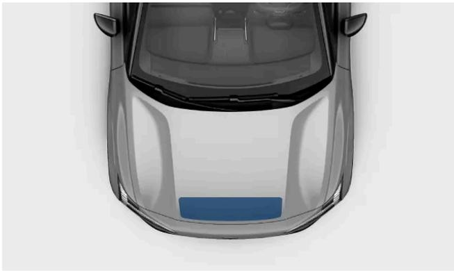
Appuyez sur le bord avant du capot avec les deux mains. Vérifiez que le capot s'enclenche dans les serrures en même temps. Tenez le bord avant à plat pendant la fermeture.
