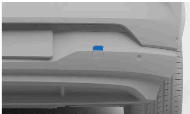
Cache de fixation d'anneau de remorquage arrière
