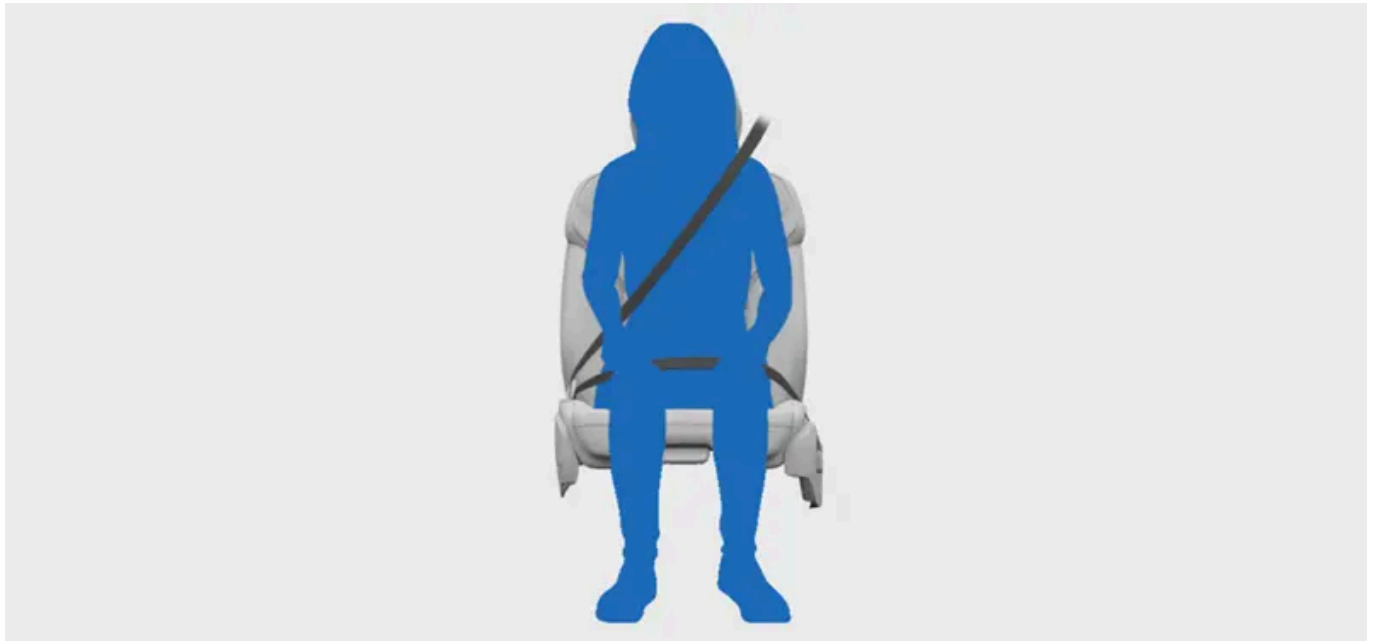
Ceinture de sécurité correctement bouclée et ajustée
