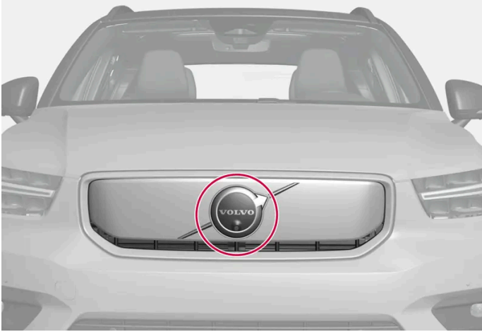
Position de l'unité radar avant
