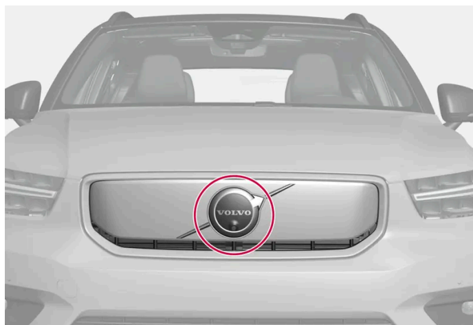
Position de l'unité radar avant
