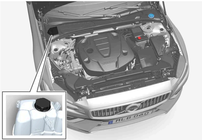
Vase d'expansion du système de refroidissement
