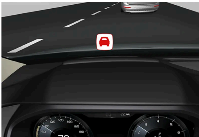
Symbole pour l'avertissement de collision sur le pare-brise
