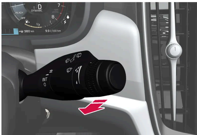
Fonction lave-glace, levier droit au volant
