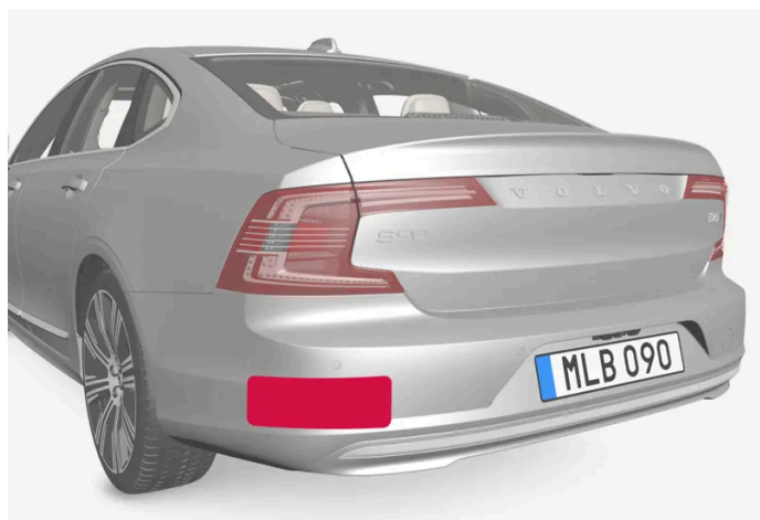
Position des unités radar arrière
