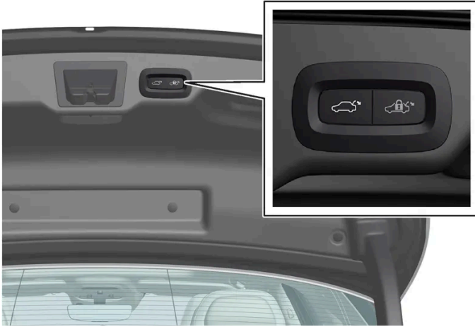
Position du bouton sur le dessous du couvercle de coffre.
