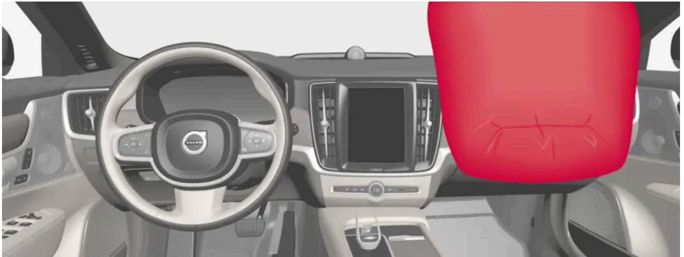
Coussin gonflable côté passager, siège avant.
