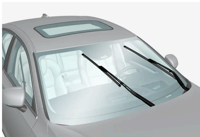
Balais d'essuie-glace en position d'entretien.
