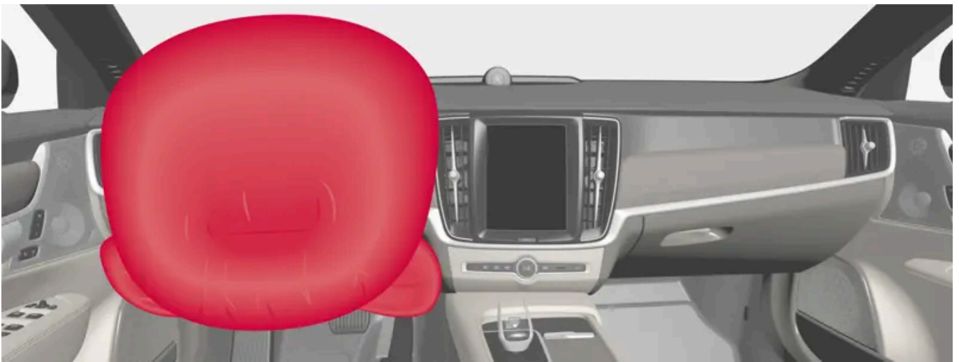
Coussin gonflable dans le volant et coussin gonflable de genoux [1] du siège avant, côté conducteur.
