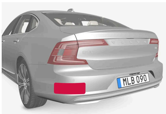
Position des unités radar arrière
