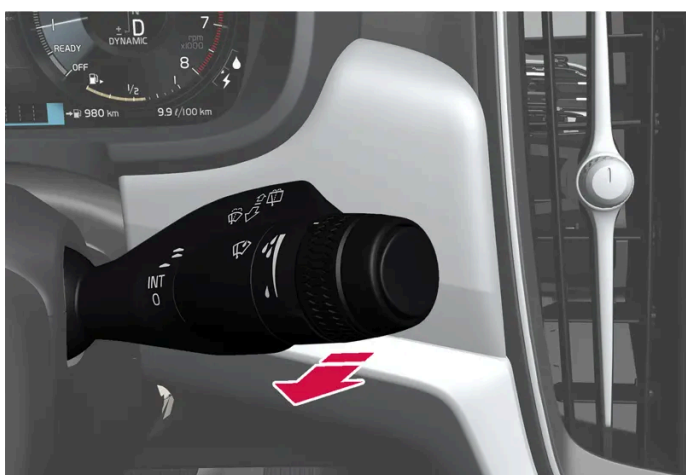
Fonction lave-glace, levier droit au volant
