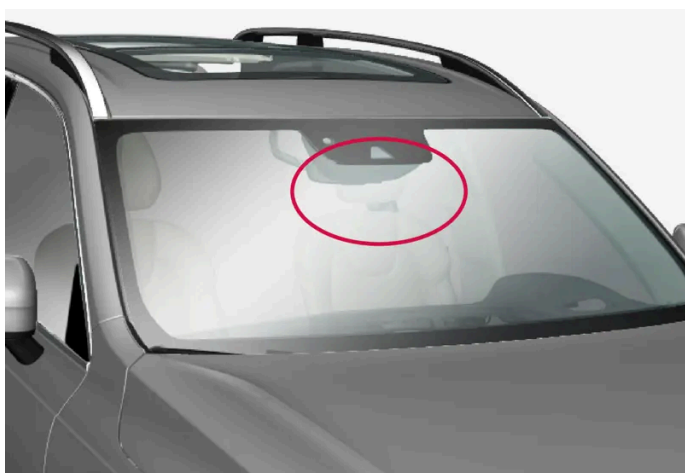
Position de l'unité de caméra avant
