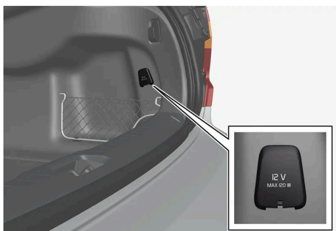
Prise électrique 12 V dans le compartiment/coffre à bagages*.
