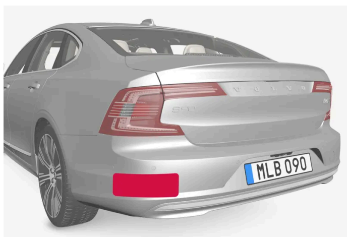
Position des unités radar arrière
