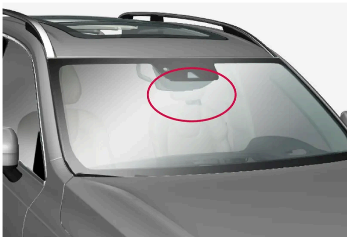
Position de l'unité de caméra avant
