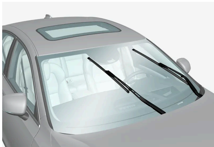
Balais d'essuie-glace en position d'entretien.
