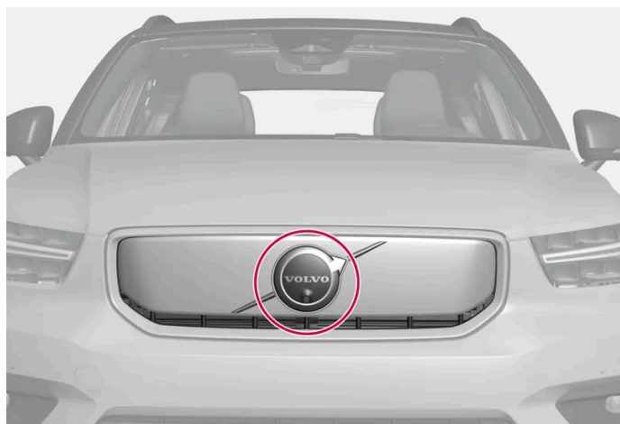
Position de l'unité radar avant
