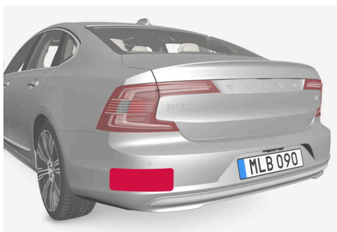
Position des unités radar arrière
