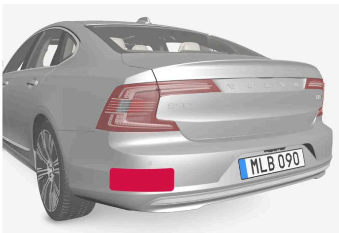
Position des unités radar arrière
