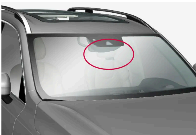
Position de l'unité de caméra avant
