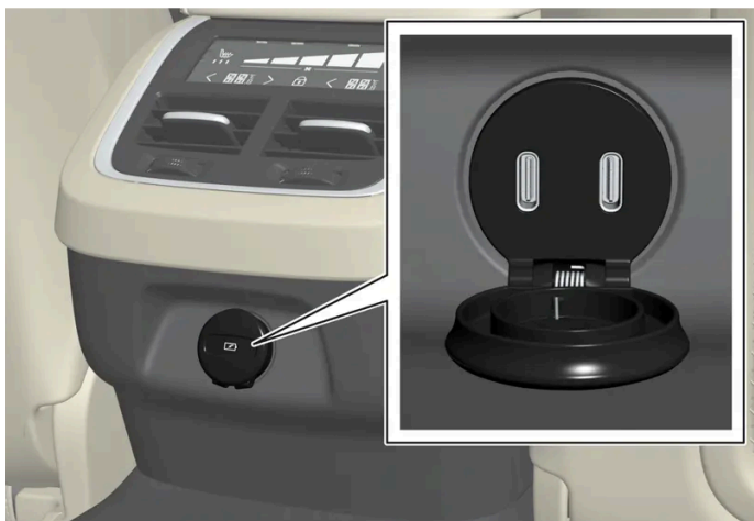
Ports USB (type C) de la console centrale, banquette arrière
