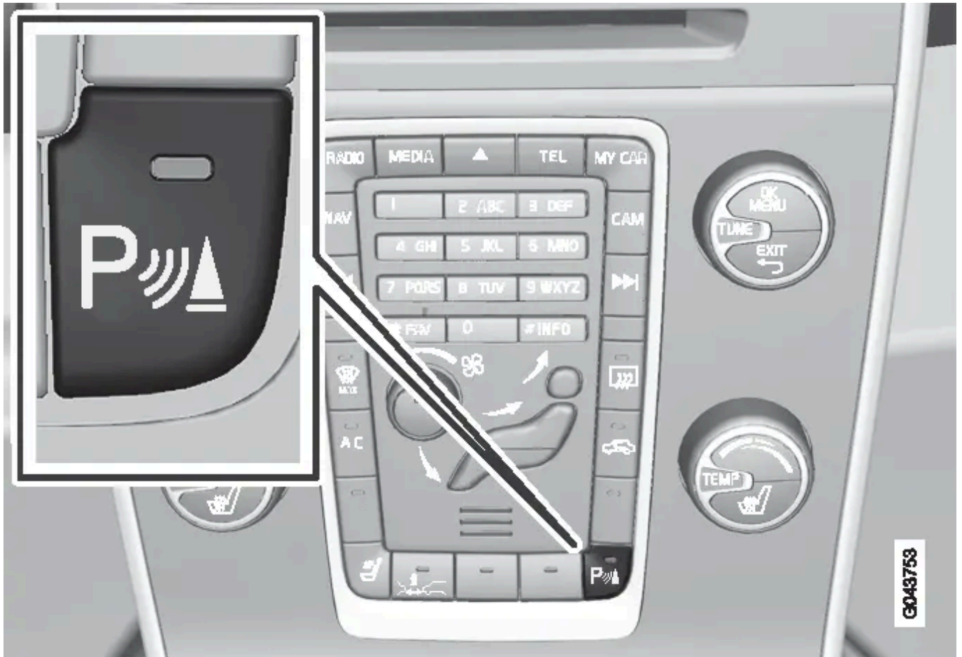
Bouton de marche/arrêt de l'aide au stationnement et de CTA.
