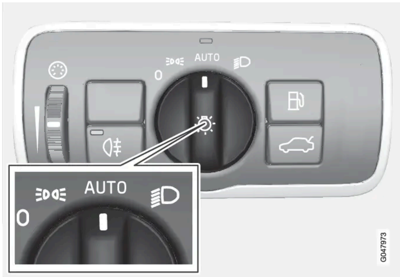
Bouton du commutateur d'éclairage en position AUTO.
