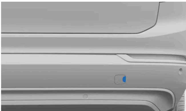
Cache de fixation d'anneau de remorquage arrière
