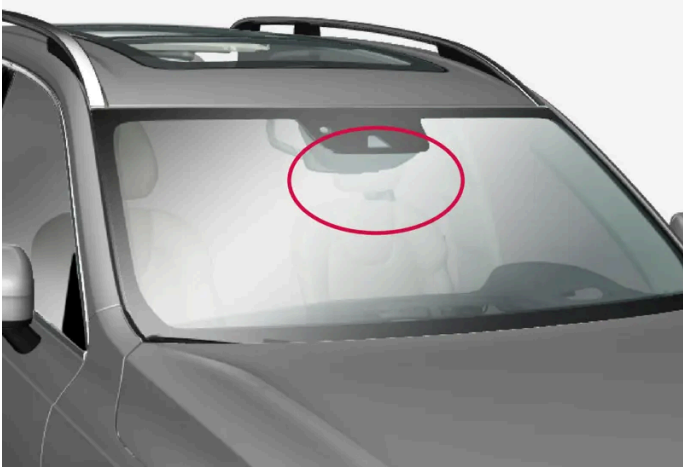
Position de l'unité de caméra avant
