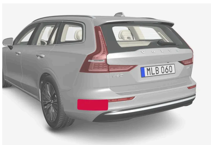
Position des unités radar arrière
