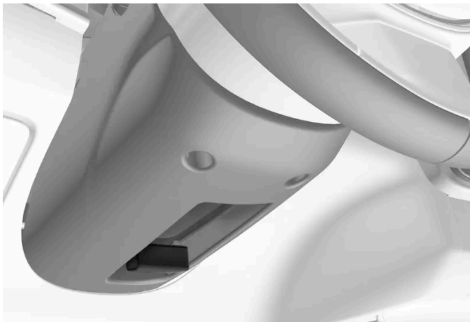
Levier de réglage du volant.
