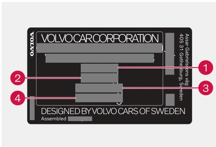
L'autocollant se trouve sur le montant de porte et visible à l'ouverture de la porte arrière droite.
