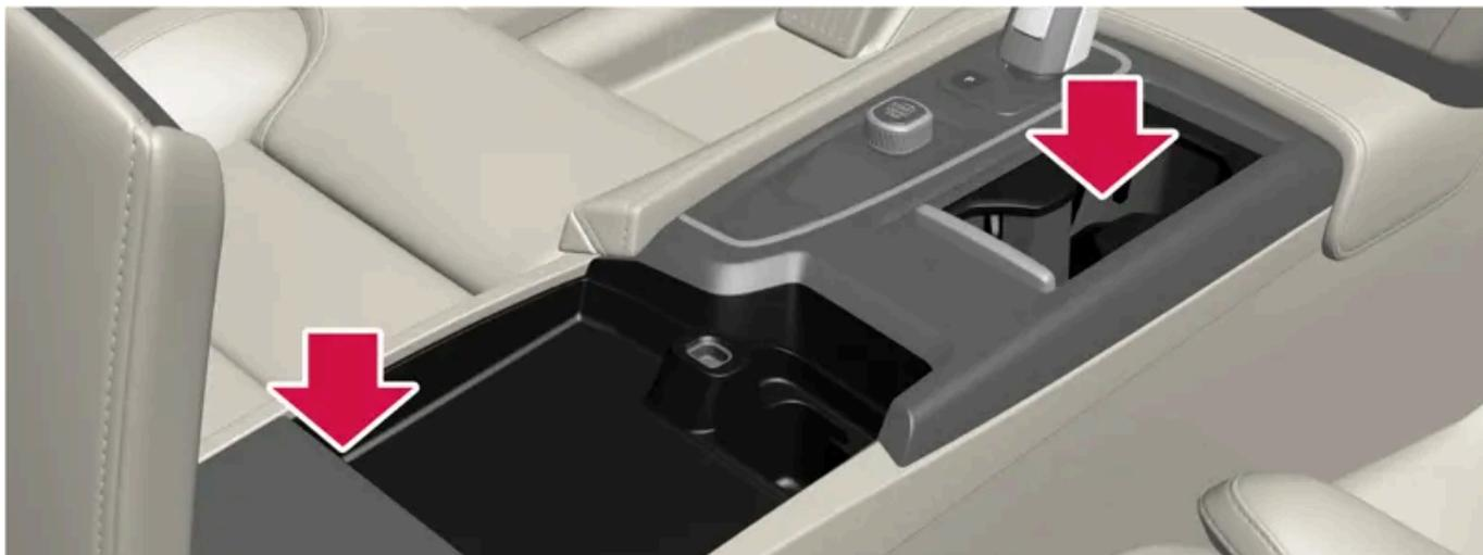
Compartiments de rangement avec porte-gobelets, prise électrique et ports USB dans la console tunnel.
