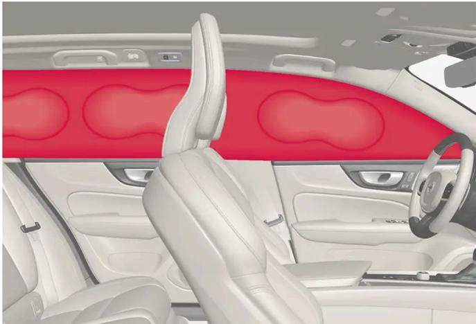
Le rideau gonflable est installé le long du plafonnier, des deux côtés et aide à protéger le conducteur et les passagers des places extérieures. Les panneaux sont marqués du symbole IC AIRBAG.
