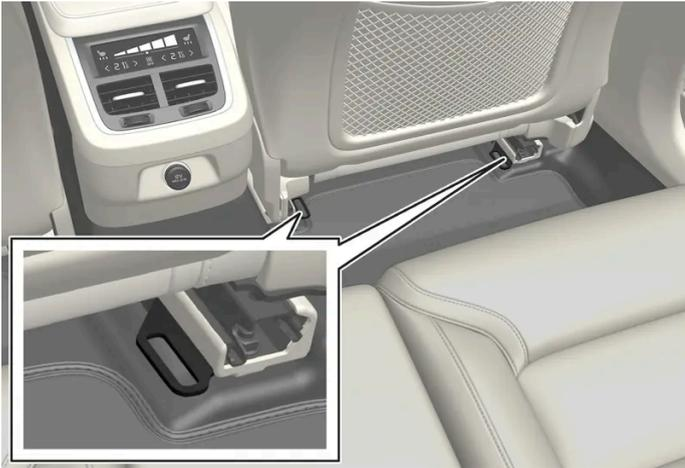
Emplacement des points de fixation sur la banquette arrière.
