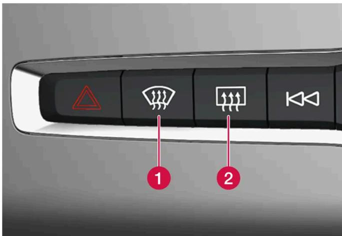
1 Bouton de pare-brise chauffant\* et de dégivrage maximal.
