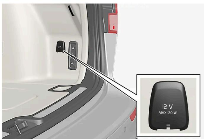
Prise électrique 12 V dans le compartiment/coffre à bagages\*.
