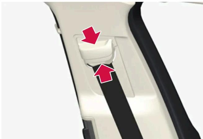
Pressez la boucle de ceinture et ajustez la hauteur de la ceinture.
