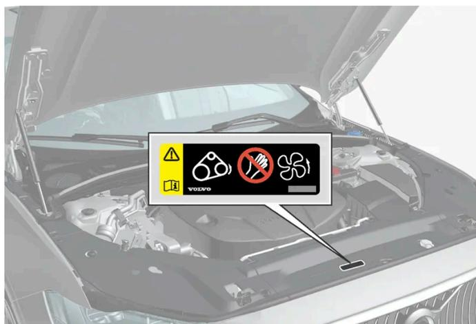
Emplacement de l'autocollant d'avertissement pour le compartiment moteur. L'aspect du compartiment moteur peut être différent suivant le modèle et la version du moteur.
