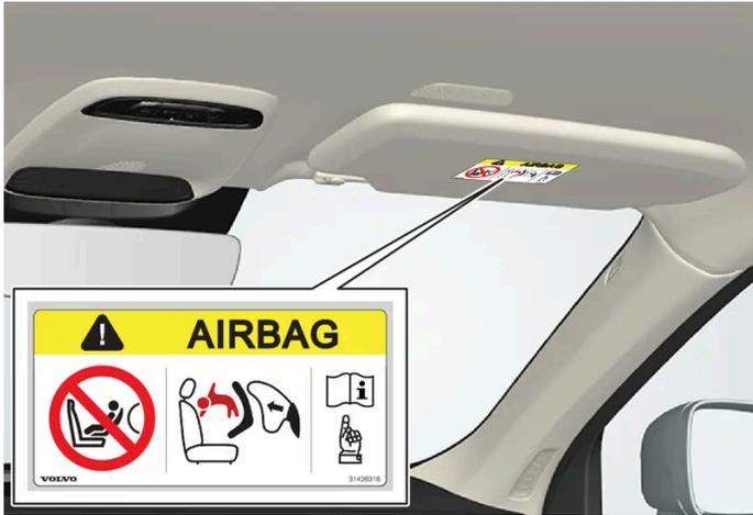
Autocollant sur le pare-soleil du côté passager.
