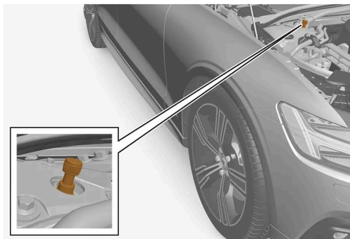
Placement de la molette de réglage de roue avant.
