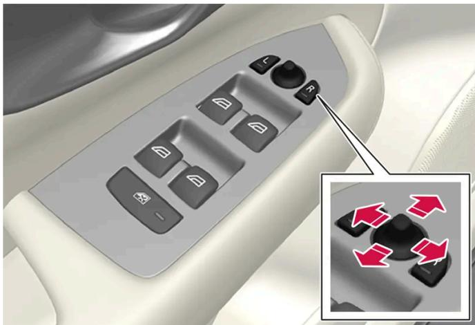
Commande des rétroviseurs extérieurs.
