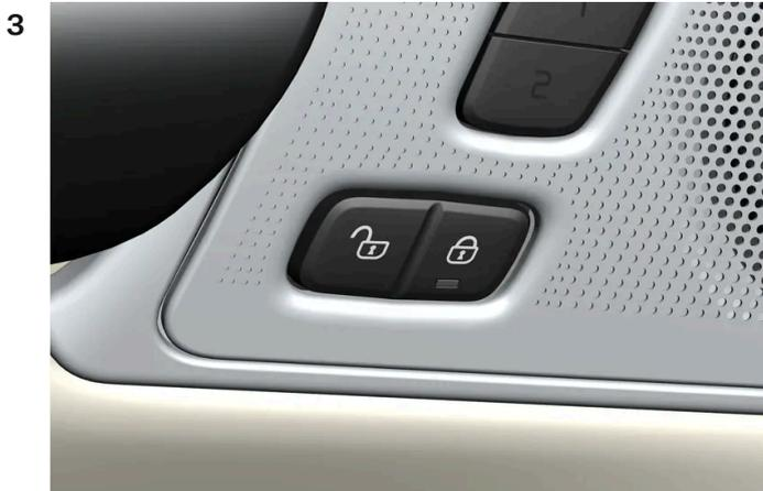
Appuyez sur le bouton de verrouillage centralisé indiqué dans l'illustration.
