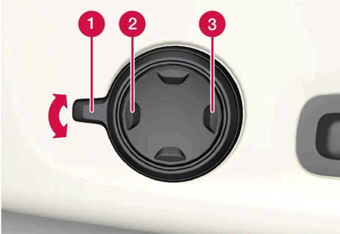
Commande multifonction placée sur le côté du coussin d'assise du siège.
