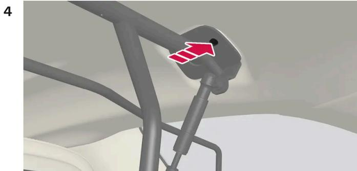
Montez la vis fournie et serrez, une clé de 6 mm est fournie. Répétez la procédure de l'autre côté. Couple de serrage recommandé : 20 Nm (15 pied-livre).
