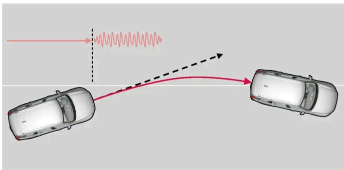
L'assistance de sortie de voie avertit le conducteur par des vibrations dans le volant.
