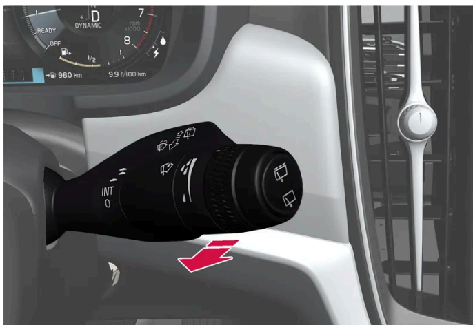
Fonction lave-glace, levier droit au volant
