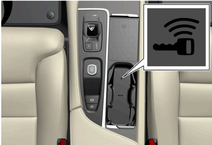
Emplacement du lecteur de secours dans la console tunnel.
