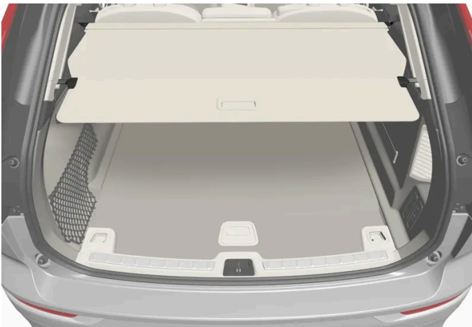
Cache-bagages en position de couverture intégrale.
