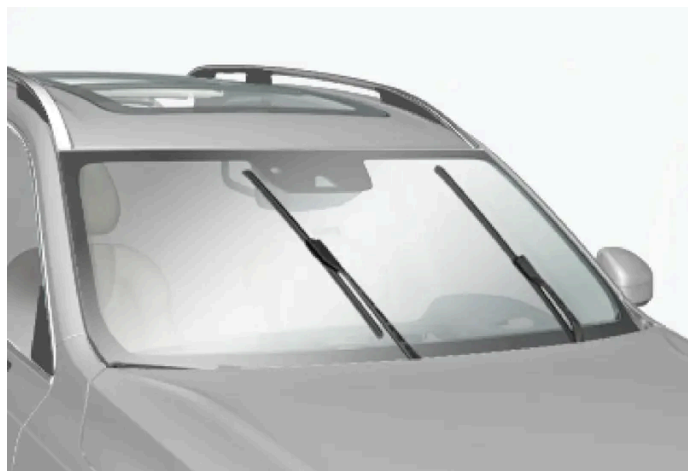
Balais d'essuie-glace en position d'entretien.
