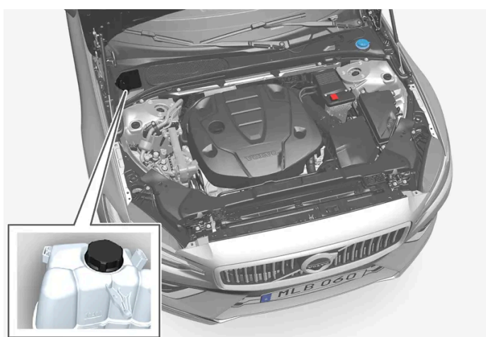
Vase d'expansion du système de refroidissement
