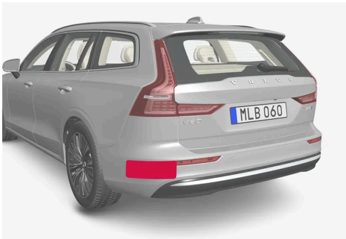
Position des unités radar arrière
