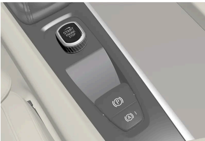
Commande de démarrage sur la console de tunnel.
