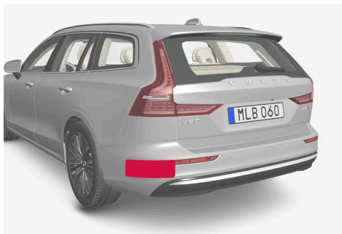
Position des unités radar arrière
