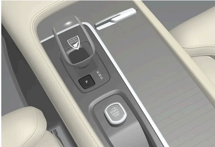
Vue d'ensemble du levier de rapport et position P.
