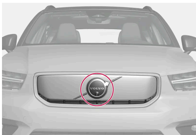
Position de l'unité radar avant
