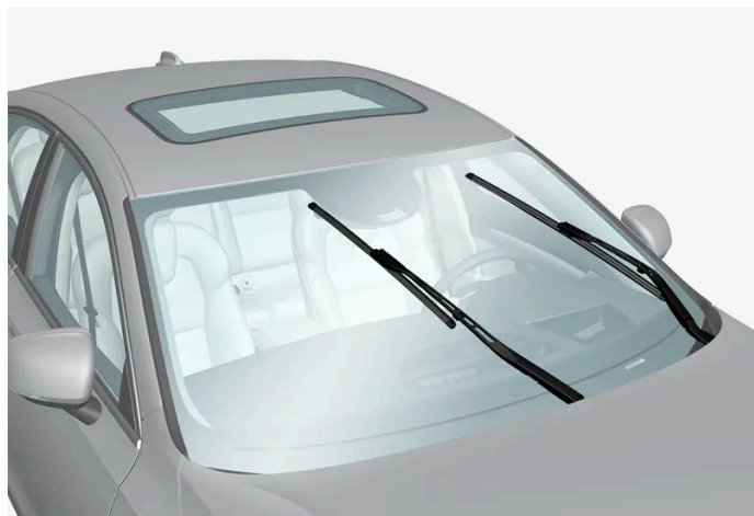
Balais d'essuie-glace en position d'entretien.
