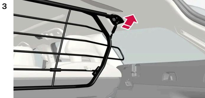
Placez les fixations de la grille de protection dans les fixations au plafond.
