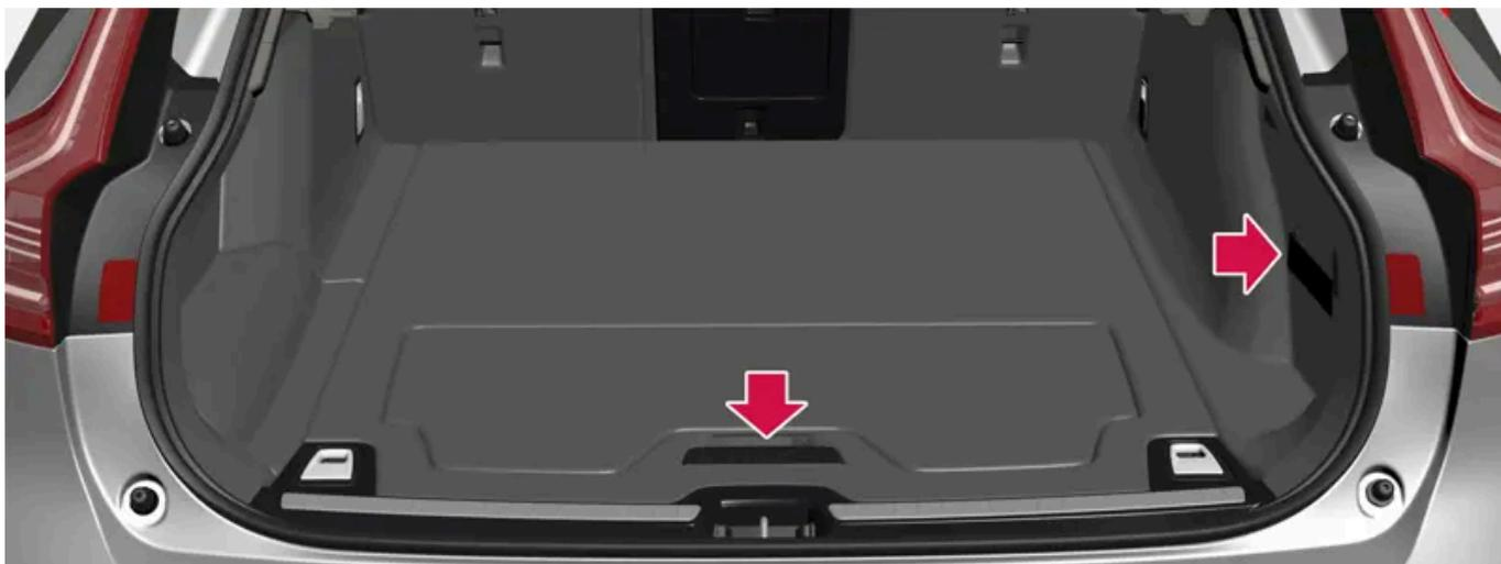
Compartiment de rangement avec bande élastique et espace de rangement sous le plancher du compartiment à bagages.
