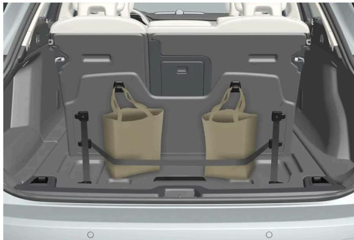
Deux crochets pour sacs à provisions et une sangle élastique<sup>[1]</sup> sont fixés sur le couvercle (partie de la trappe de plancher) dans le compartiment à bagages. La sangle peut être installée selon quatre positions différentes.
