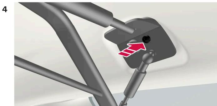
Montez la vis fournie et serrez à l'aide de la clé fournie de 6 mm. Répétez la procédure de l'autre côté. Couple de serrage recommandé : 20 Nm (15 pied-livre).
