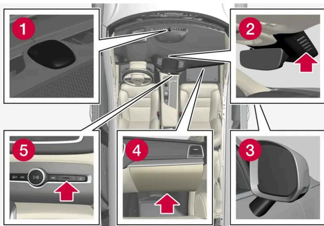
❶ Capteur d'ensoleillement - sur la partie supérieure du tableau de bord.
