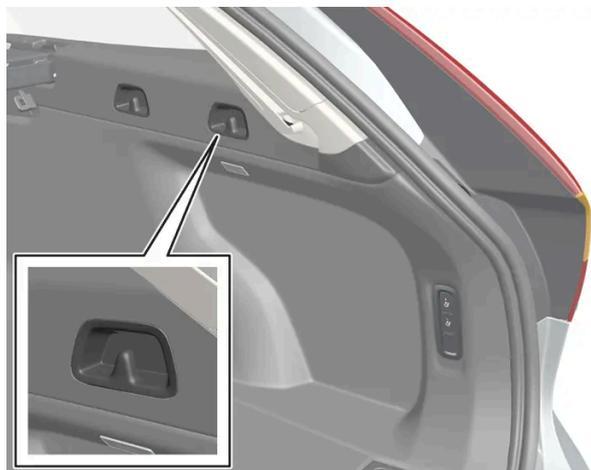
Les panneaux latéraux comportent également deux crochets pour sacs à provisions (un de chaque côté du compartiment à bagages).
