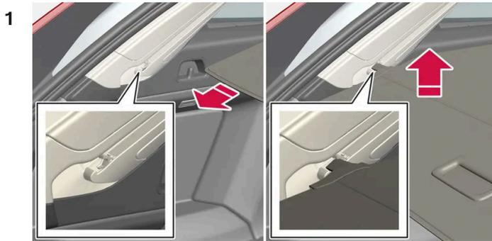
Saisissez la poignée et tirez le cache-bagages pour le passer au-dessus des panneaux latéraux du compartiment à bagages. Tirez jusqu'au bout.
