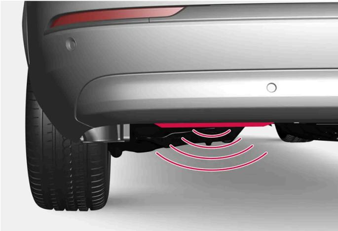
Le capteur est placé légèrement à gauche sur le pare-choc.
