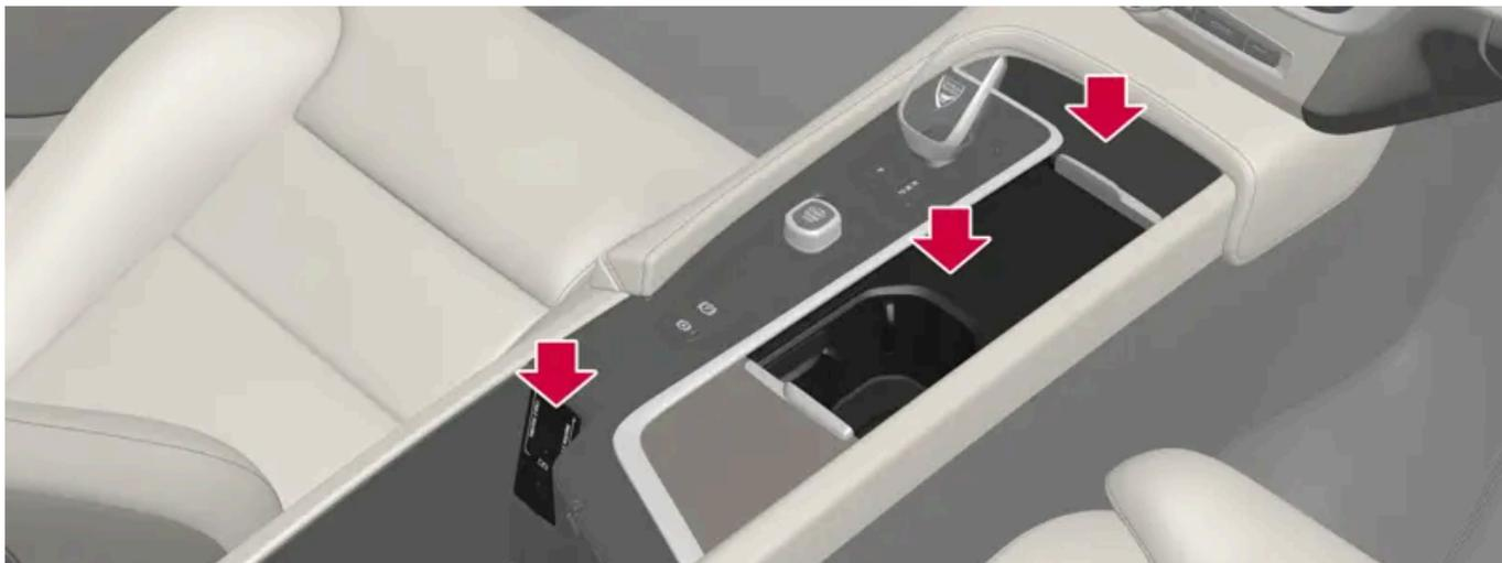
Compartiments de rangement avec porte-gobelets, chargeur de téléphone par induction\*, prises électriques et ports USB dans la console tunnel.
