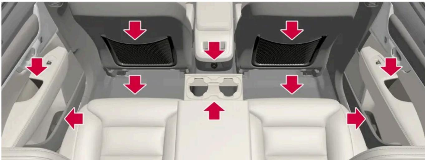
Compartiment de rangement dans le panneau de porte, porte-gobelets\* dans le dossier de la place centrale, compartiment de rangement\* sur le dossier du siège avant et ports USB dans la console tunnel.
