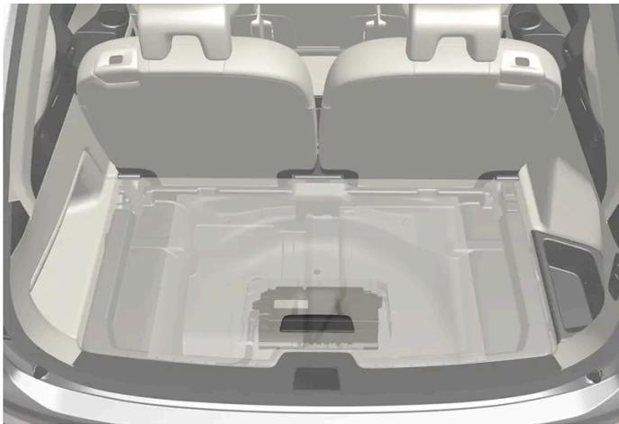
Les véhicules de type microhybride disposent d'une batterie auxiliaire de 48 V placée sous le compartiment à bagages. Les interventions sur la batterie et sur son boîtier doivent être effectuées uniquement par un atelier agréé.
