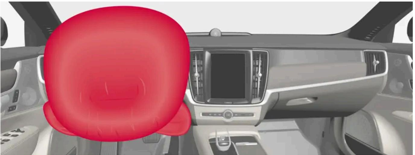
Coussin gonflable dans le volant et coussin gonflable de genoux<sup>[1]</sup> du siège avant, côté conducteur.
