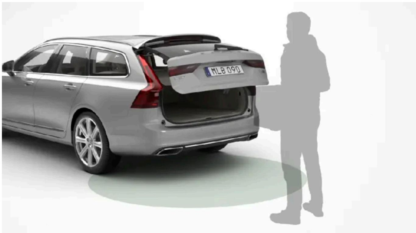
Si la voiture est équipée du verrouillage et déverrouillage sans clé\*, il est possible de déverrouiller le hayon avec un mouvement du pied.
