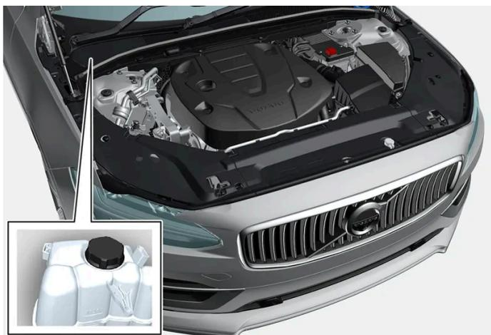
Vase d'expansion du système de refroidissement, voiture à conduite à droite.
