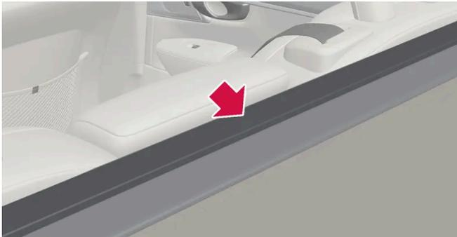
Sortez la partie avant du cache-bagages pour recouvrir l'espace situé entre le cache-bagages et le dossier de la banquette arrière.
