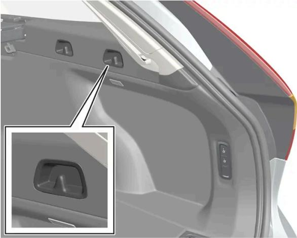
Les panneaux latéraux comportent également deux crochets pour sacs à provisions (un de chaque côté du compartiment à bagages).
