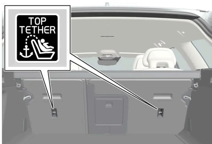
L'emplacement des points de fixation pour la banquette arrière est indiqué par des symboles sur la face arrière du dossier.
