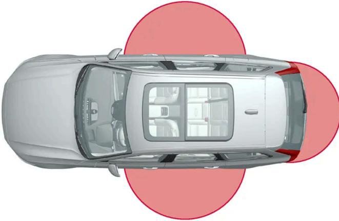
Pour les fonctions sans clé, une clé doit se trouver à une distance de 1 à 1,5 mètre (3 à 5 pieds) environ des portes ou du hayon de la voiture.
