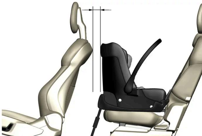
Lors du montage du siège bébé sur la banquette arrière, Volvo recommande de laisser une distance d'au moins 50 mm (2 pouces) entre la partie avant du siège bébé et la face arrière du siège avant.
