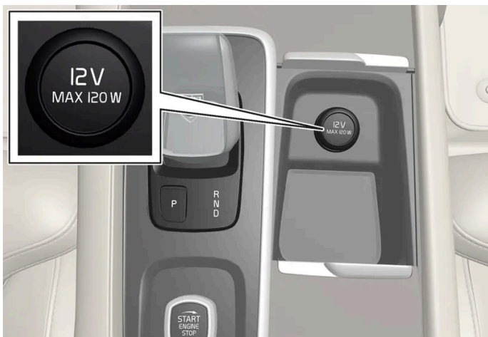
Prise électrique avant de console de tunnel pour voitures sans chargeur de téléphone par induction*.
