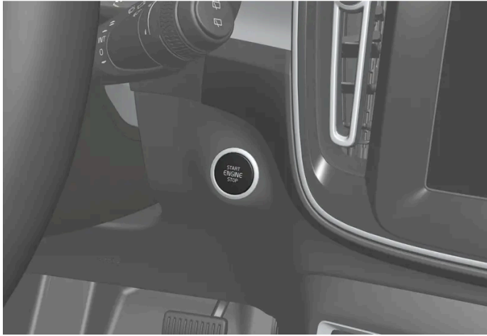
Emplacement de la commande de démarrage.
