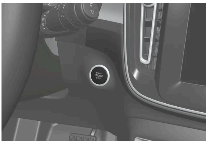
Emplacement de la commande de démarrage.
