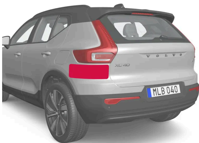
Position des unités radar arrière
