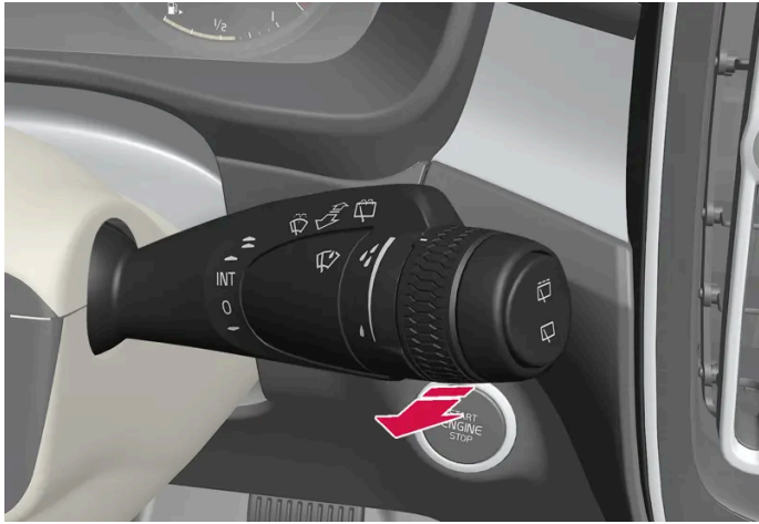
Fonction lave-glace, levier droit au volant
