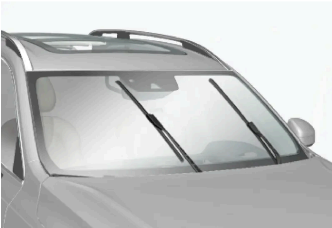
Balais d'essuie-glace en position d'entretien.
