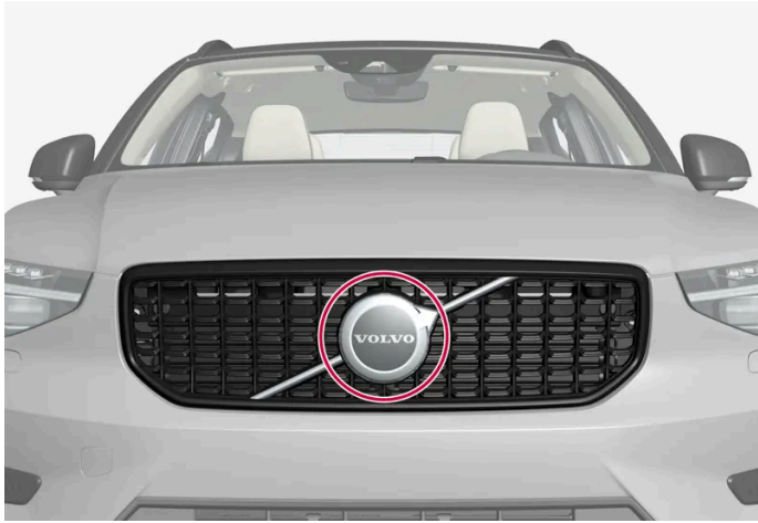
Position de l'unité radar avant
