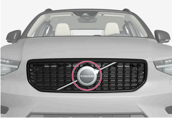
Position de l'unité radar avant
