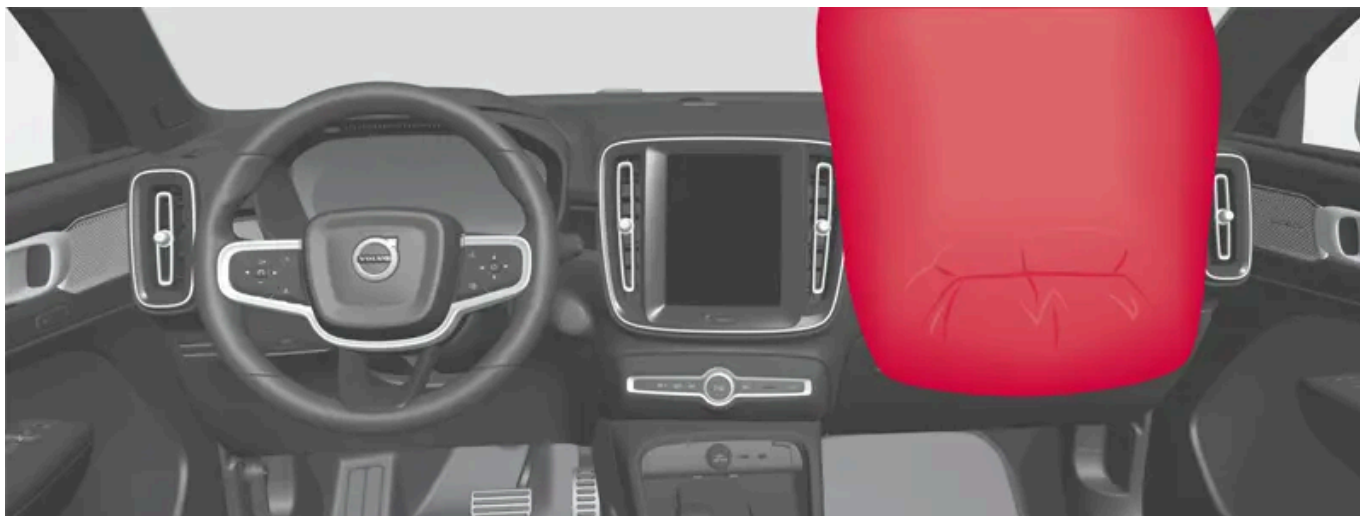
Coussin gonflable côté passager, siège avant.
