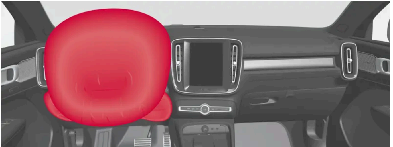
Coussin gonflable dans le volant et coussin gonflable de genoux [1] du siège avant, côté conducteur.
