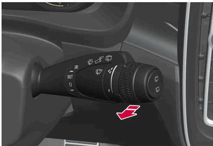
Fonction lave-glace, levier droit au volant
