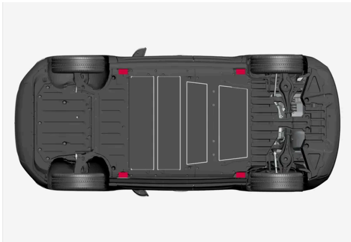
Points de levage de la voiture avec un cric.
