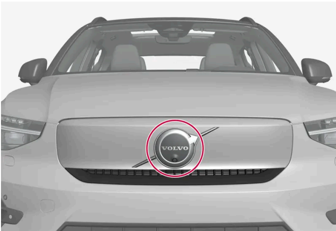
Position de l'unité radar avant
