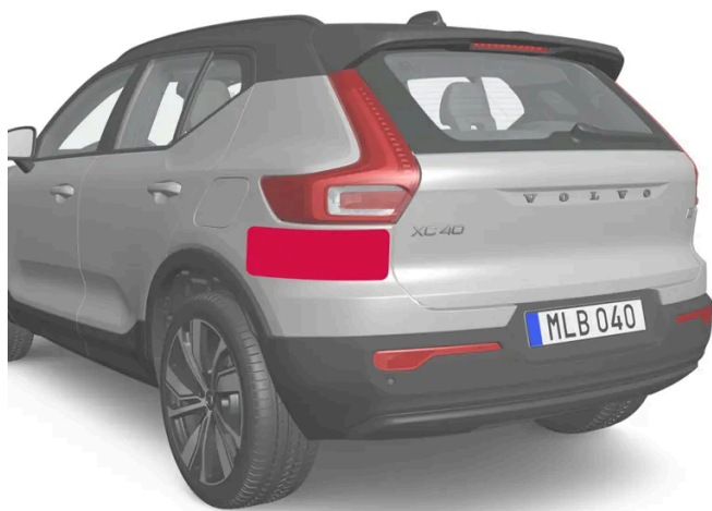
Position des unités radar arrière
