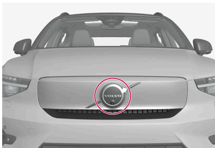
Position de l'unité radar avant
