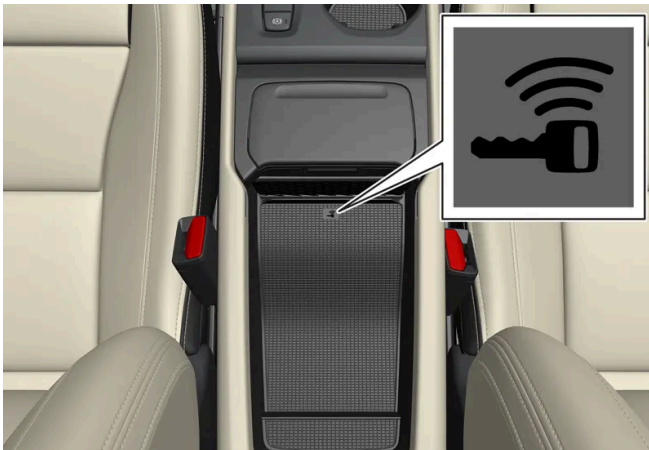
Emplacement du lecteur de secours dans le compartiment de rangement.
