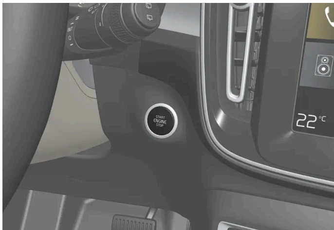
Emplacement de la commande de démarrage.
