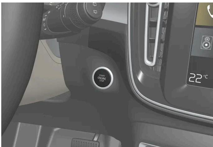
Emplacement de la commande de démarrage.
