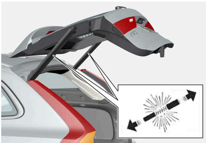
Les vérins du hayon à commande électrique.
