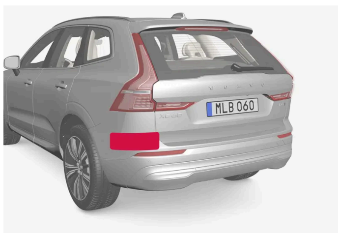
Position des unités radar arrière
