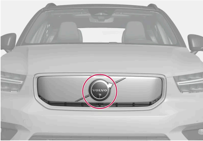
Position de l'unité radar avant
