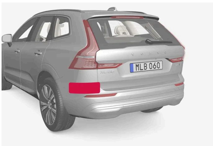
Position des unités radar arrière
