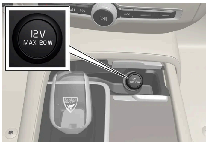
Prise électrique avant de console de tunnel pour voitures avec chargeur de téléphone par induction*.
