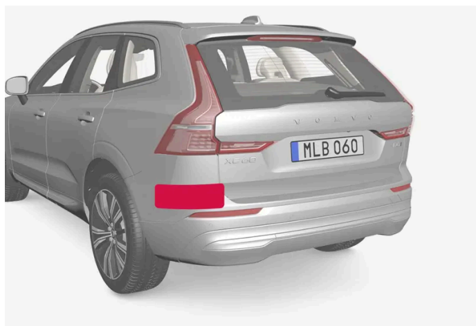
Position des unités radar arrière
