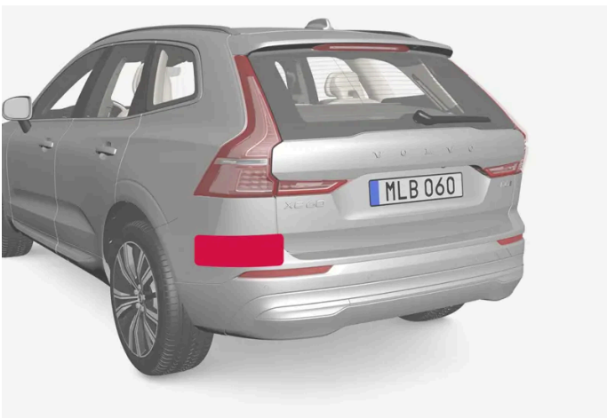
Position des unités radar arrière
