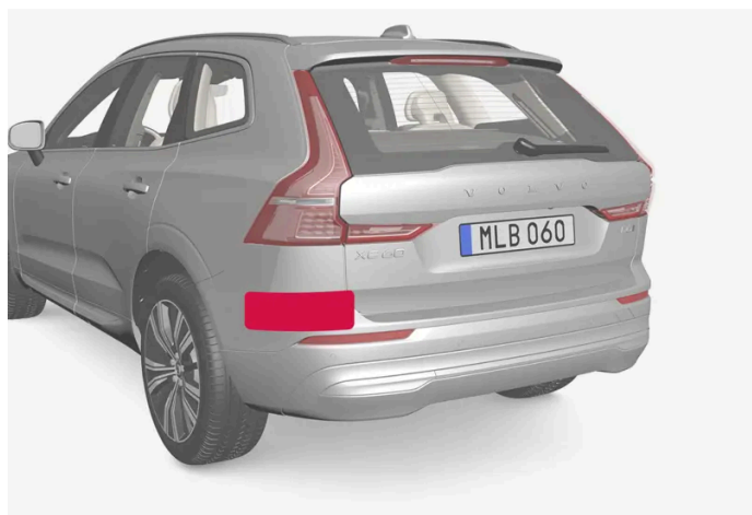
Position des unités radar arrière
