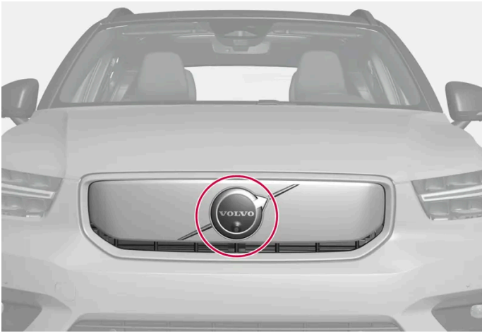
Position de l'unité radar avant
